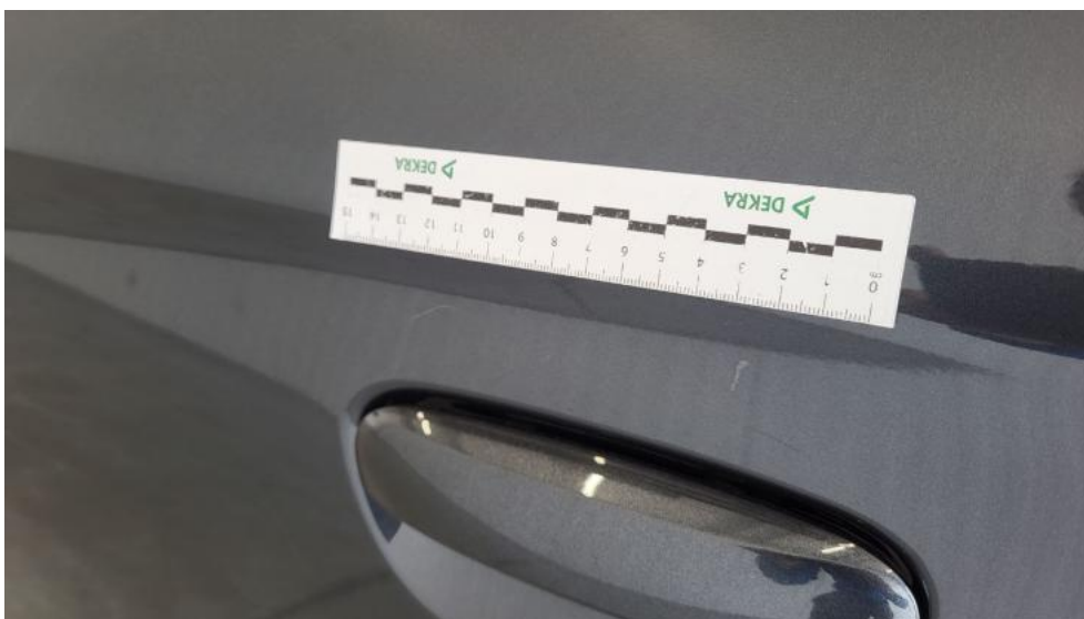
Photo 56. Drzwi tylne L - Rysa/odprysk 2
