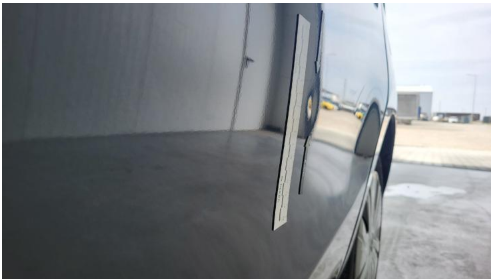
Photo 57. Drzwi tylne L - Wgniecenie/odkształcenie 1
