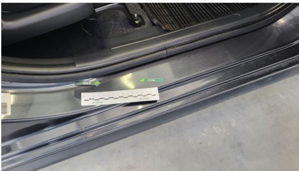
Photo 45. Próg P - Wgniecenie/odkształcenie 1
