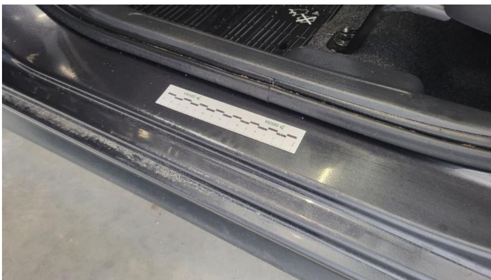
Photo 58. Próg L - Rysa/odprysk 1
