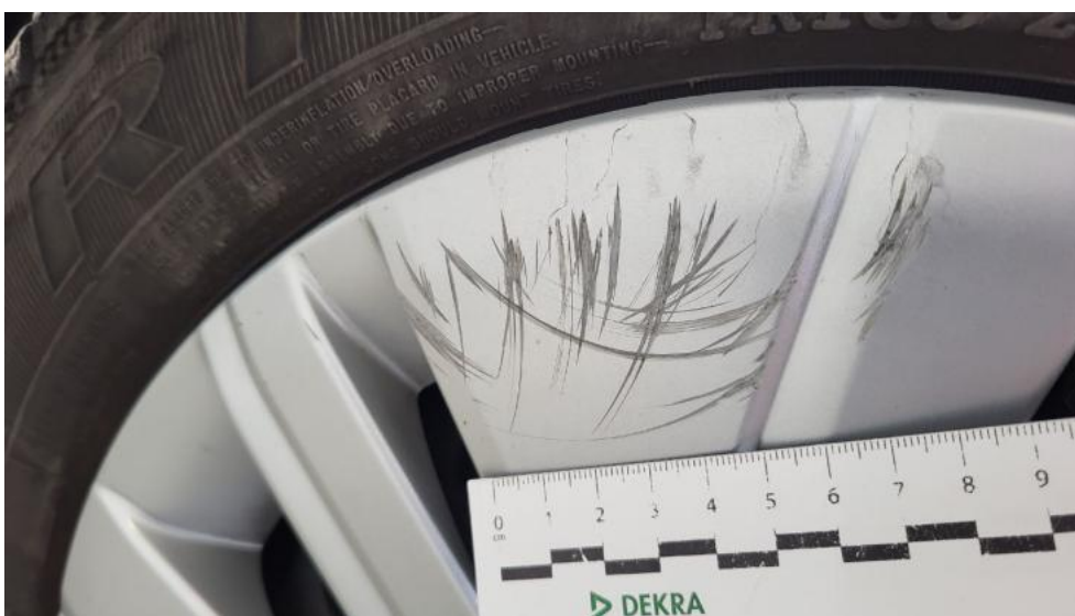
Photo 62. Kołpak przedni L - Rysa/odprysk 1
