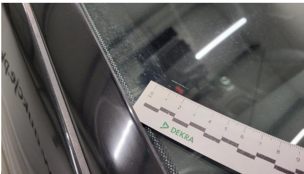
Fot. 43. Szyba czołowa - Rysa/odprysk 1
