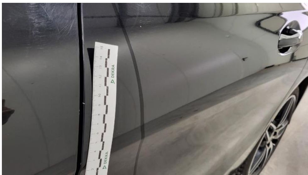
Fot. 71. Drzwi tylne L - Rysa/odprysk 1
