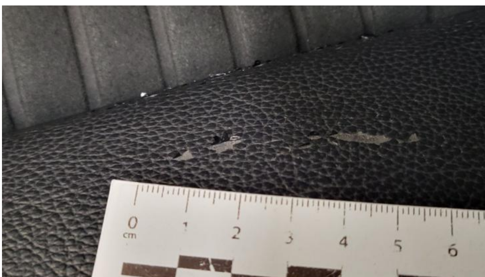
Fot. 76. Fotel prz. lew. - Pęknięcie/rozerwanie 1
