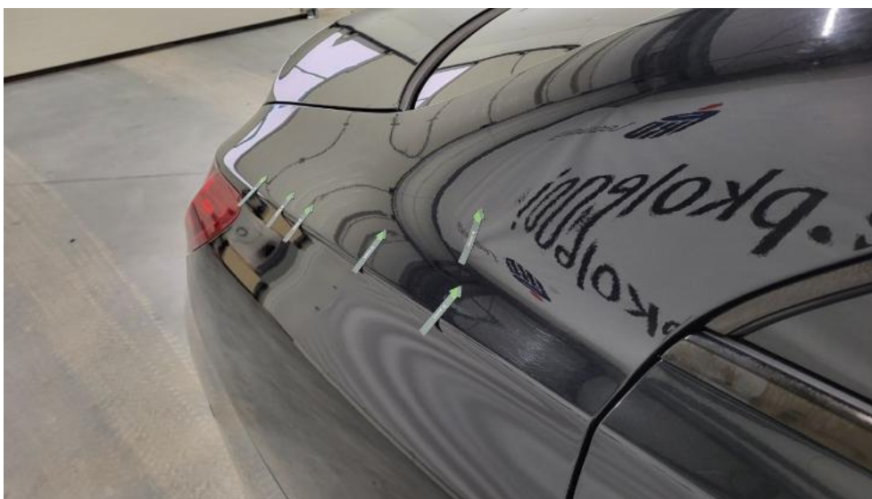
Fot. 53. Błotnik tylny P / Ściana boczna P() - Wgniecenie/odkształcenie 3
