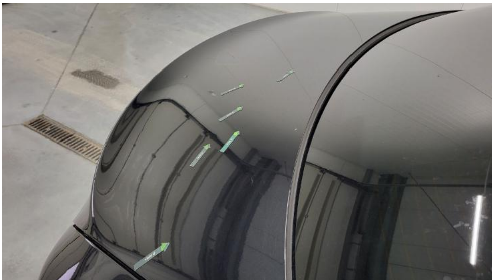
Fot. 55. Pokrywy bagażnika - Wgniecenie/odkształcenie 1
