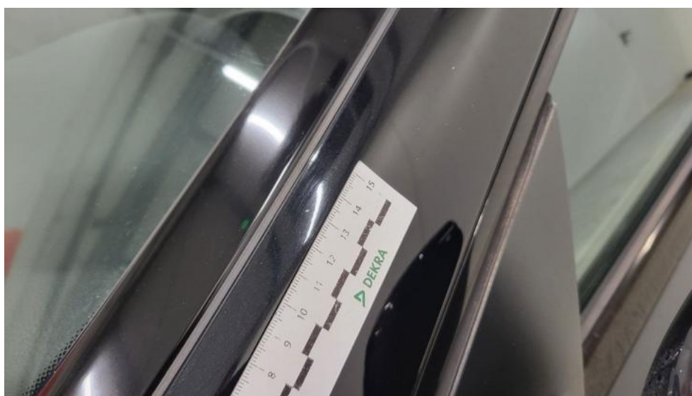
Fot. 72. Słupki przedni L - Rysa/odprysk 1
