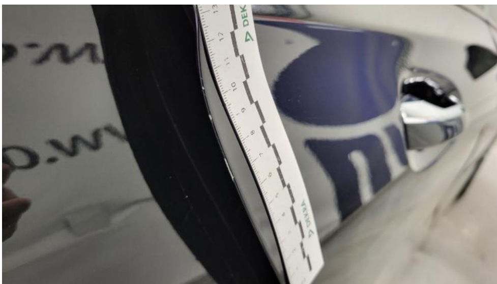
Fot. 48. Drzwi tylne P - Rysa/odprysk 1
