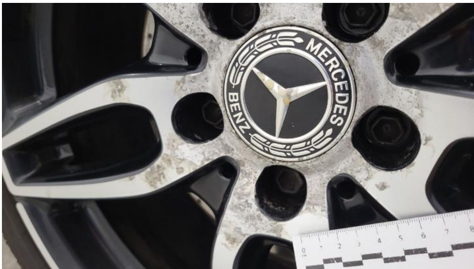
Fot. 45. Felga aluminiowa przednia P - Rysa/odprysk 1
