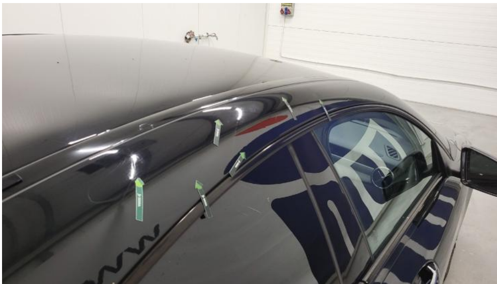
Fot. 51. Błotnik tylny P / Ściana boczna P - Wgniecenie/odkształcenie 1
