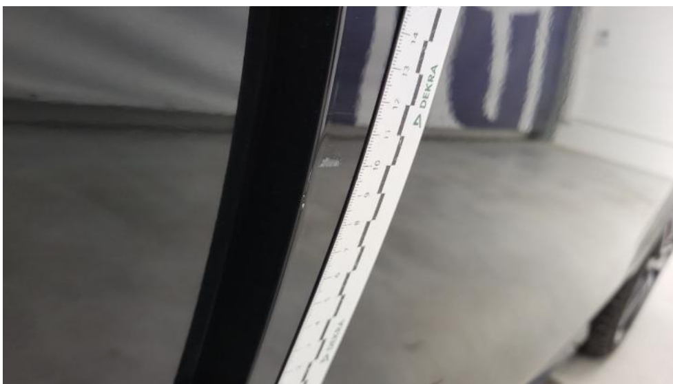
Fot. 46. Drzwi przednie P - Rysa/odprysk 1
