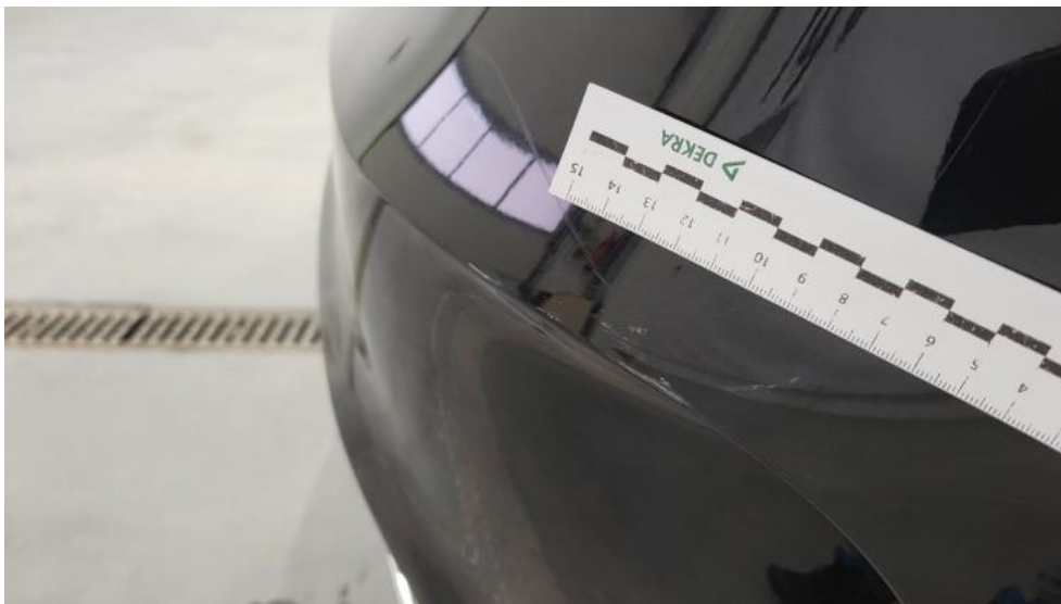
Fot. 57. Zderzak tylny - Rysa/odprysk 1
