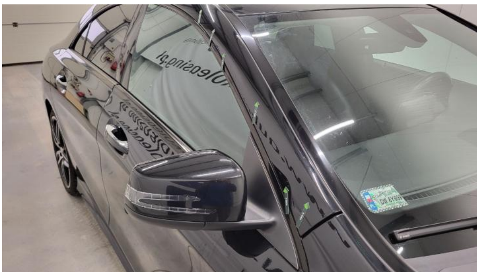
Fot. 50. Słupek przedni P - Wgniecenie/odkształcenie 1
