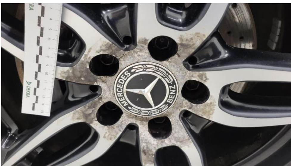
Fot. 74. Felga Aluminiowa przednia L - Rysa/odprysk 1
