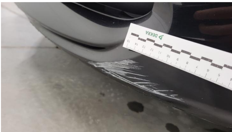
Fot. 44. Zderzak - Rysa/odprysk 1
