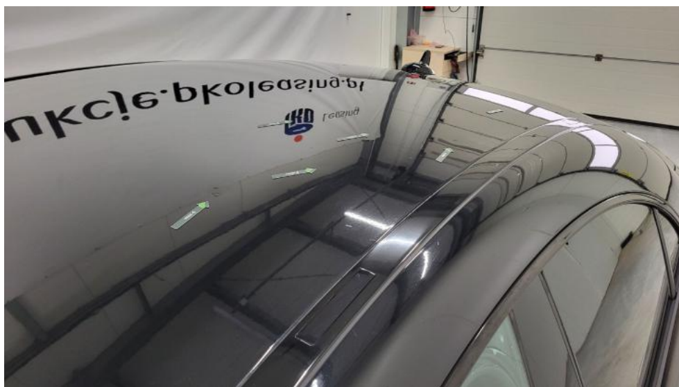
Fot. 61. Dach() - Wgniecenie/odkształcenie 3
