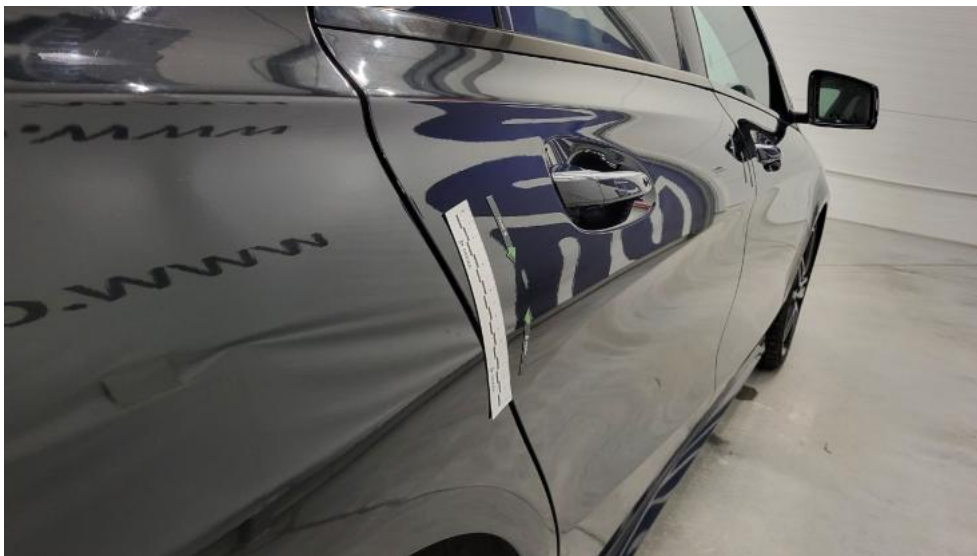
Fot. 49. Drzwi tylne P - Wgniecenie/odkształcenie 1
