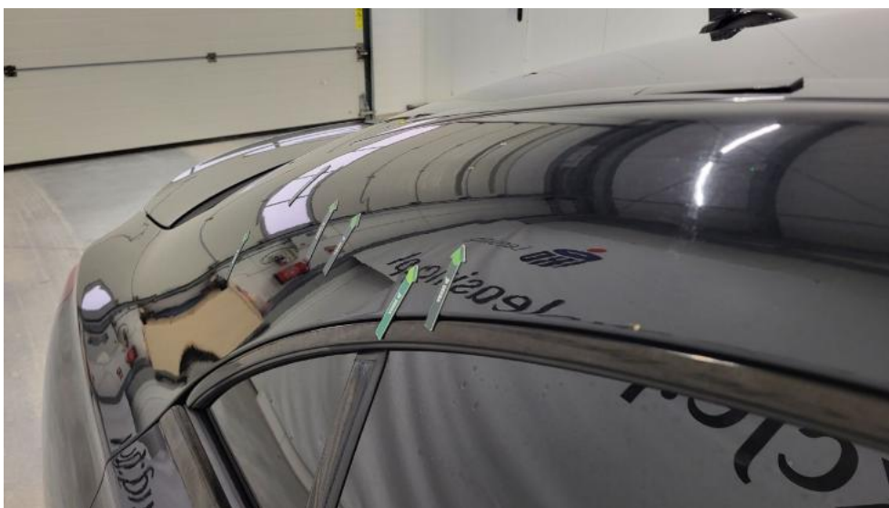
Fot. 52. Błotnik tylny P / Ściana boczna P - Wgniecenie/odkształcenie 2
