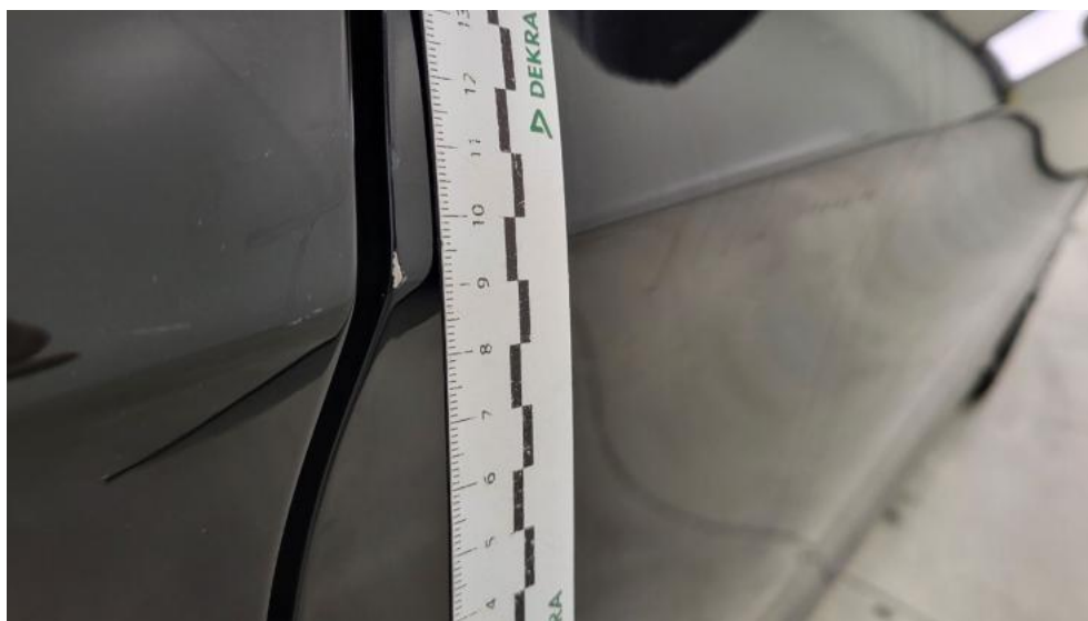
Fot. 69. Drzwi przed L - Rysa/odprysk 2
