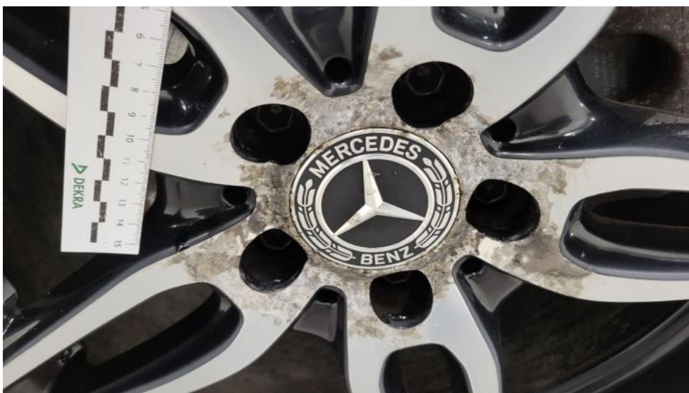
Fot. 66. Felga aluminiowa tylna L - Rysa/odprysk 1
