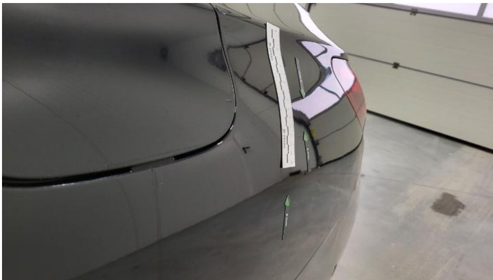
Fot. 65. Błotnik tylny L / Ściana boczna L - Wgniecenie/odkształcenie 2
