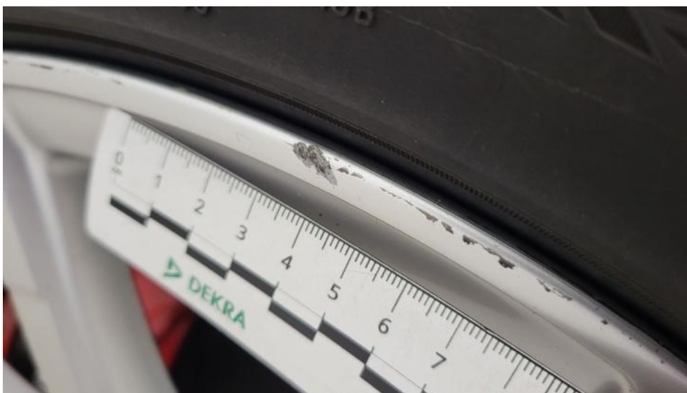
Photo 63. Felga aluminiowa przednia P - Rysa/odprysk 1
