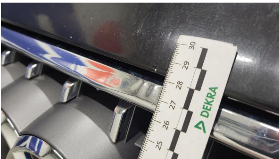
Photo 58. Pokrywa komory silnika - Rysa/odprysk 1
