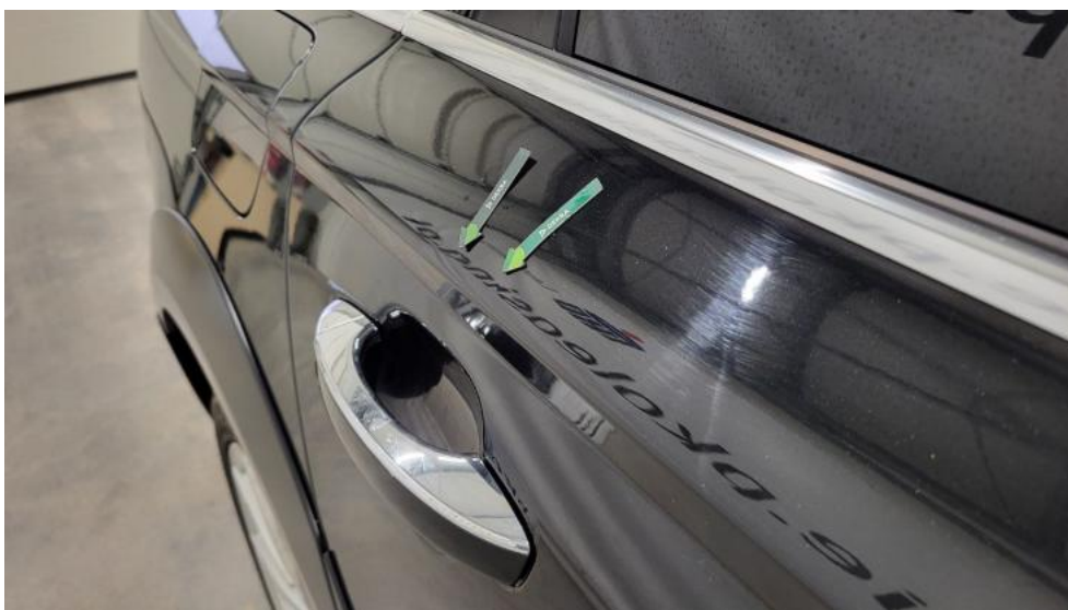
Photo 68. Drzwi tylne P - Wgniecenie/odkształcenie 1
