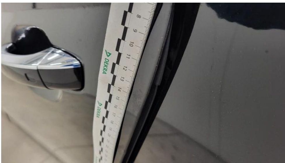
Photo 83. Drzwi tylne L - Rysa/odprysk 1
