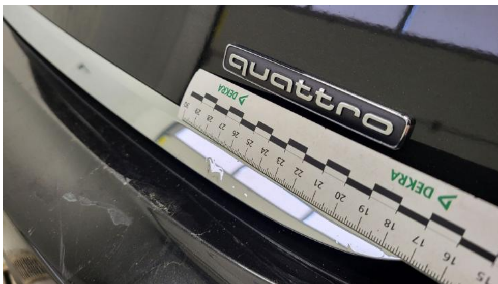
Photo 73. Pokrywy bagażnika - Wgniecenie/odkształcenie 1
