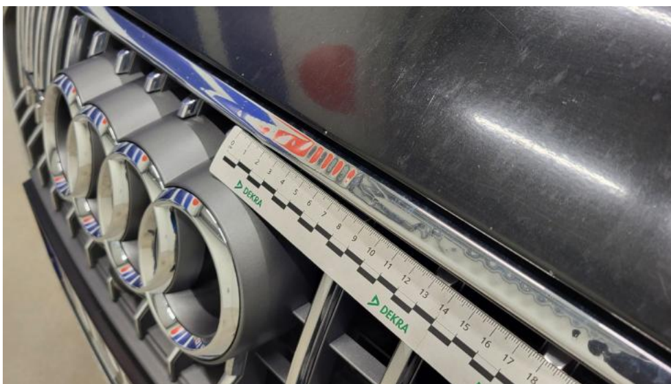
Photo 57. Listwa śr zderzaka przedniego - Wgniecenie/odkształcenie 1
