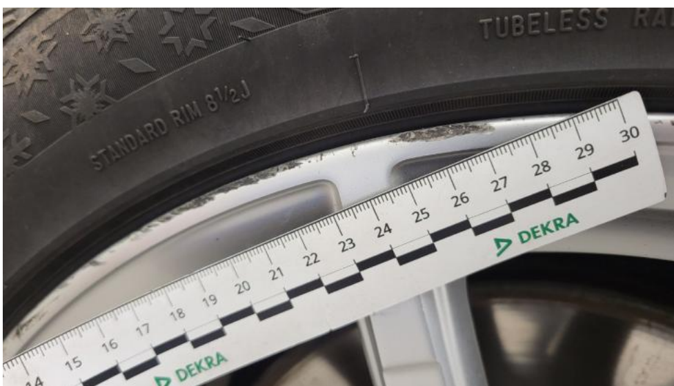
Photo 84. Felga Aluminiowa przednia L - Rysa/odprysk 1
