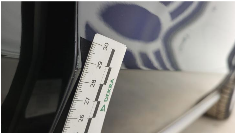
Photo 65. Drzwi przednie P - Rysa/odprysk 1
