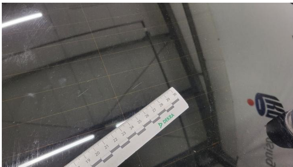
Photo 74. Szyba tylna - Rysa/odprysk 1
