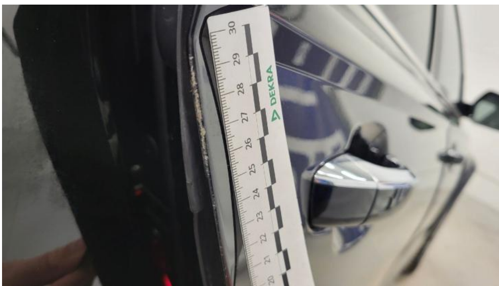
Photo 67. Drzwi tylne P - Rysa/odprysk 2
