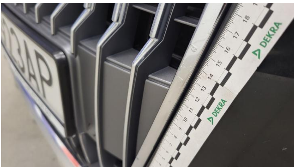
Photo 56. Listwa śr zderzaka przedniego - Rysa/odprysk 1
