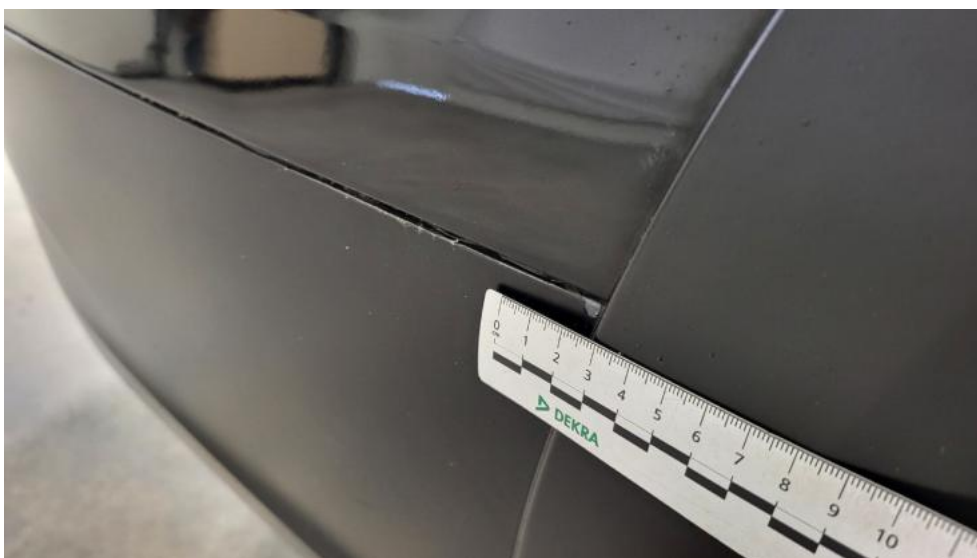
Photo 76. Zderzak tylny cz dolna - Rysa/odprysk 1
