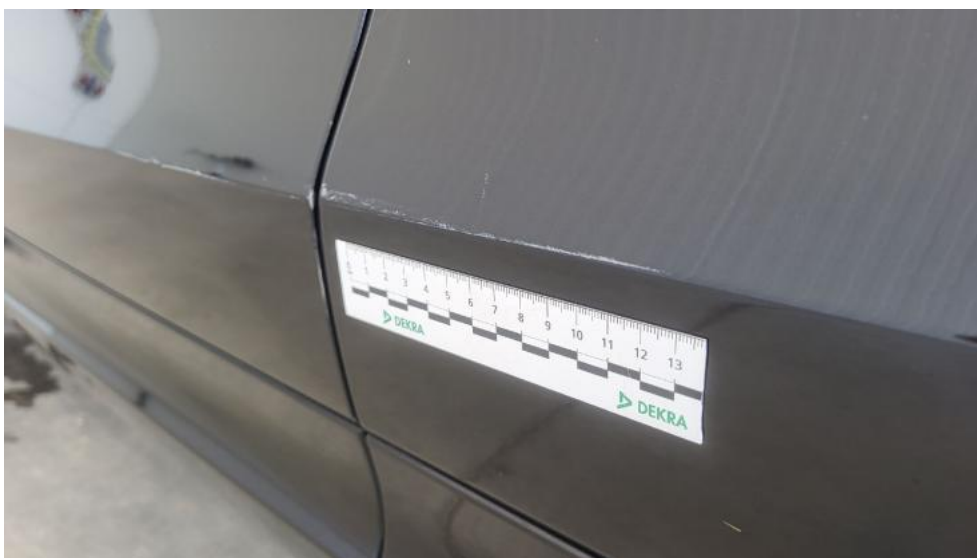
Fot. 74. Drzwi tylne L - Rysa/odprysk 2
