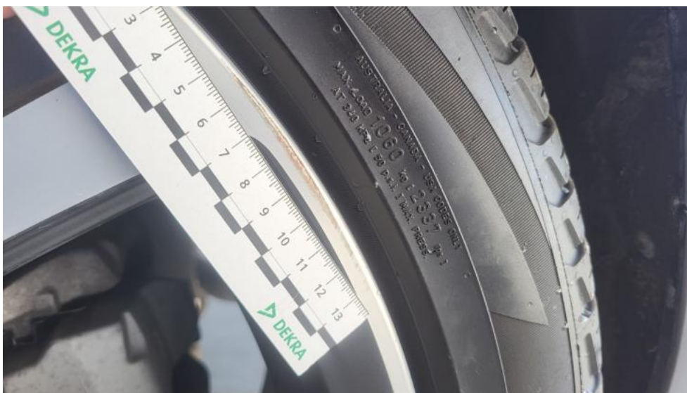
Fot. 69. Felga aluminiowa tylna L - Rysa/odprysk 1
