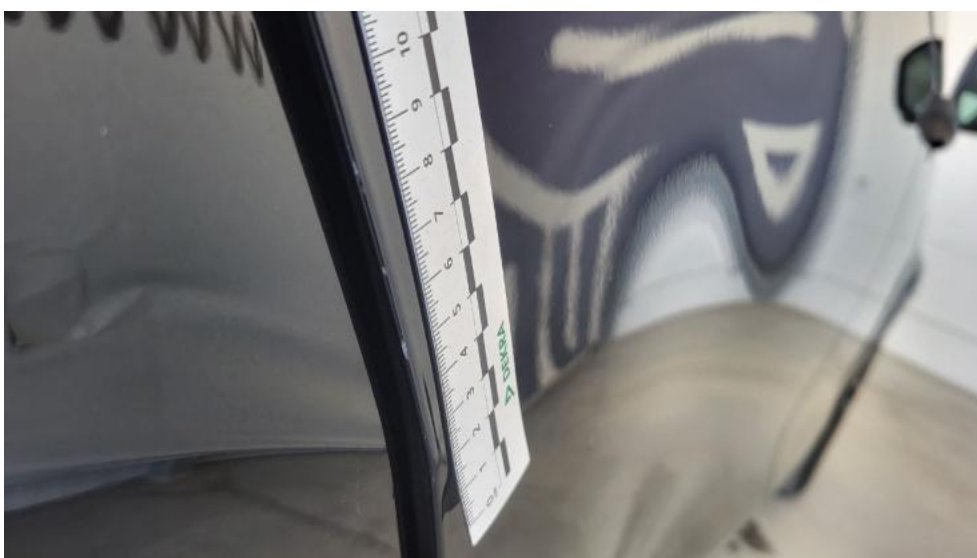
Fot. 58. Drzwi tylne P - Rysa/odprysk 1
