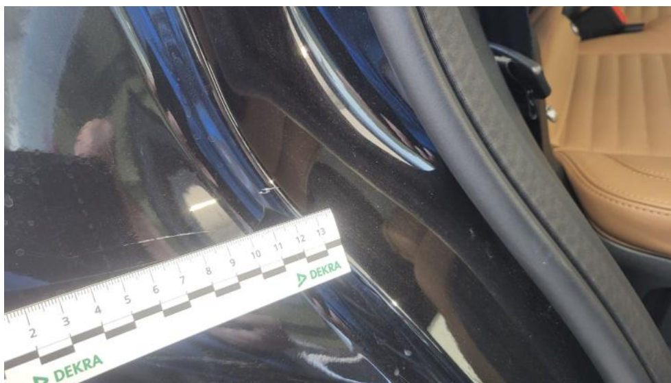
Fot. 61. Błotnik tylny P / Ściana boczna P - Rysa/odprysk 1
