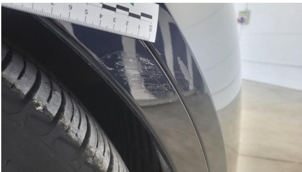
Fot. 54. Listwa krawędzi błotnika prz P - Rysa/odprysk 1
