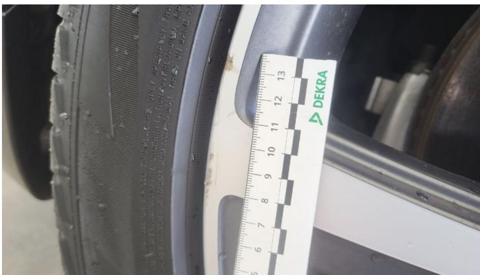
Fot. 77. Felga Aluminiowa przednia L - Rysa/odprysk 1
