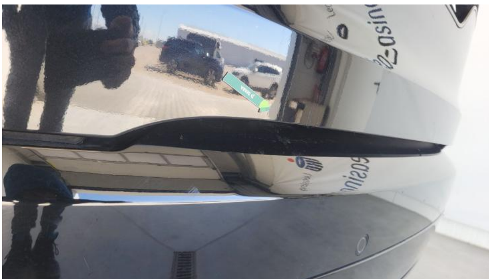
Fot. 65. Pokrywy bagażnika - Wgniecenie/odkształcenie 1
