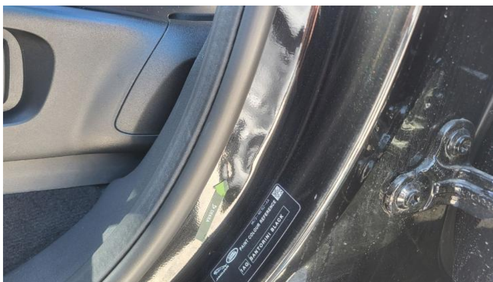
Fot. 76. Słupek środkowy L - Wgniecenie/odkształcenie 1
