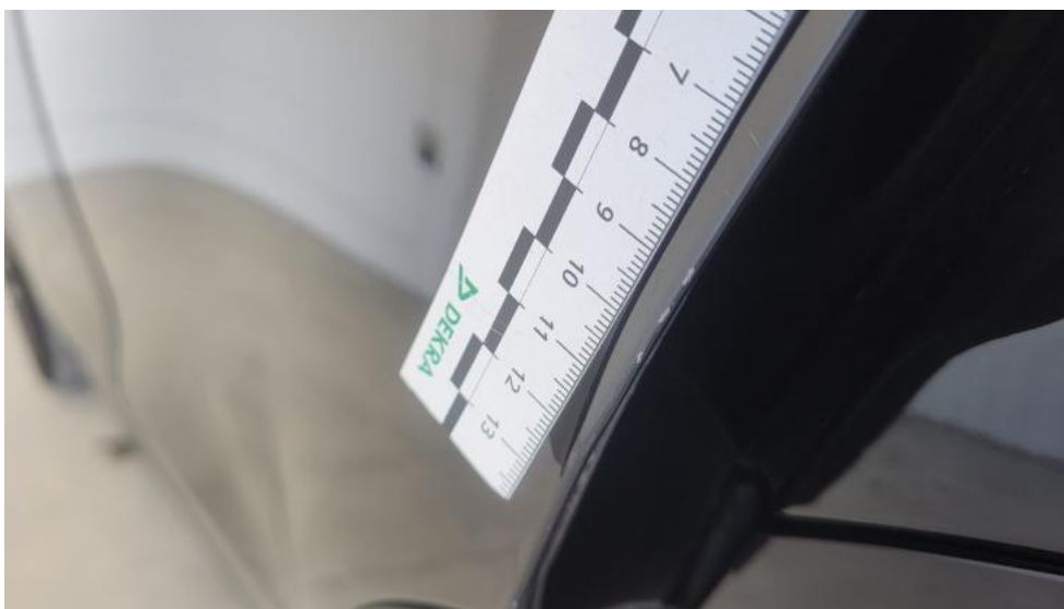
Fot. 73. Drzwi tylne L - Rysa/odprysk 1
