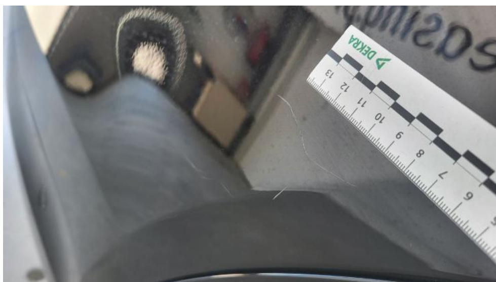
Fot. 62. Błotnik tylny P / Ściana boczna P - Rysa/odprysk 2
