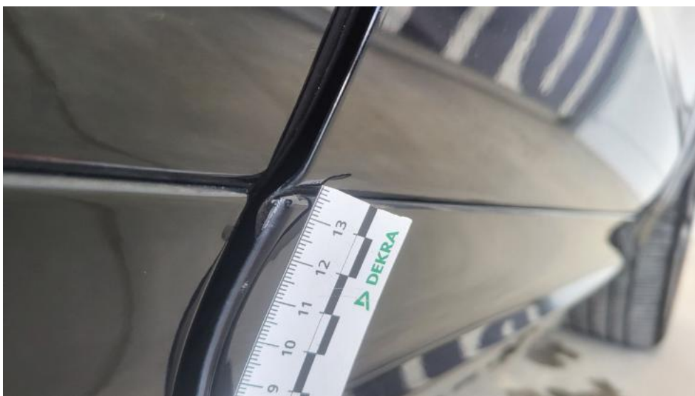
Fot. 60. Listwa drzwi przednich P - Rysa/odprysk 1
