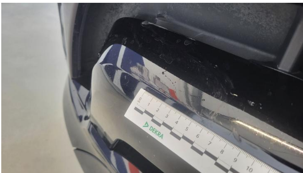
Fot. 48. Listwa śr zderzaka przedniego - Rysa/odprysk 1
