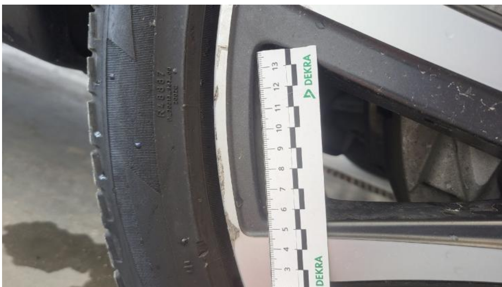
Fot. 53. Felga aluminiowa przednia P - Rysa/odprysk 1
