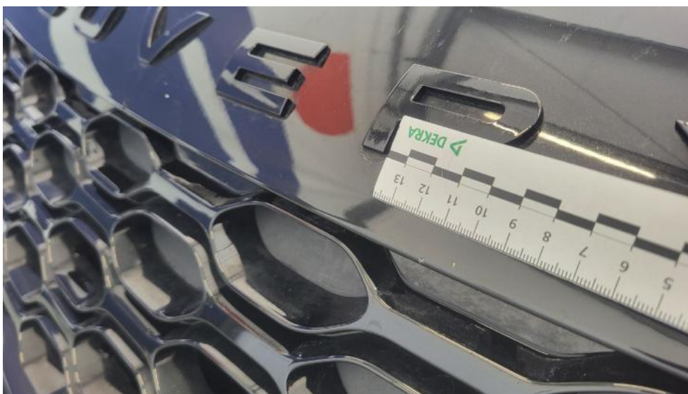
Fot. 49. Pokrywa komory silnika - Rysa/odprysk 1
