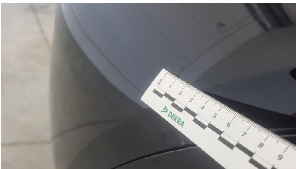
Fot. 50. Zderzak - Rysa/odprysk 1
