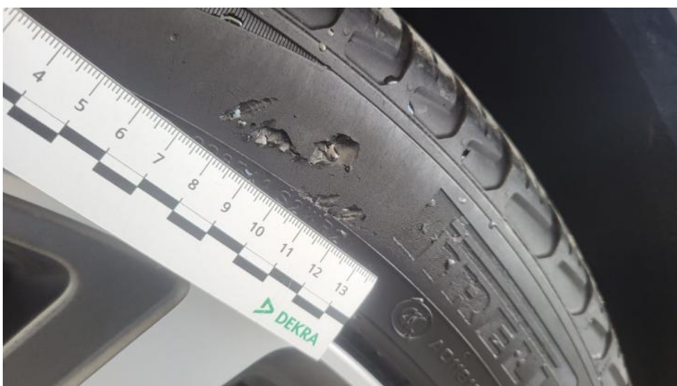
Fot. 78. Opona przednia L - Pęknięcie/rozerwanie 1
