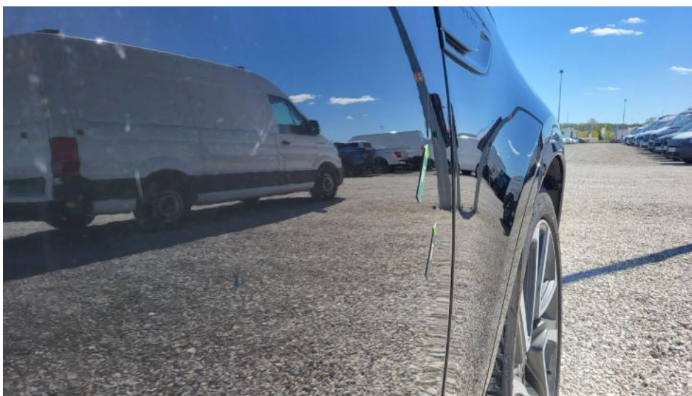
Fot. 57. Drzwi przednie P - Wgniecenie/odkształcenie 1
