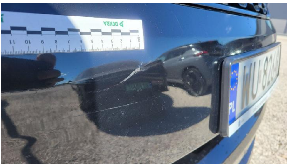
Fot. 52. Zderzak - Wgniecenie/odkształcenie 1
