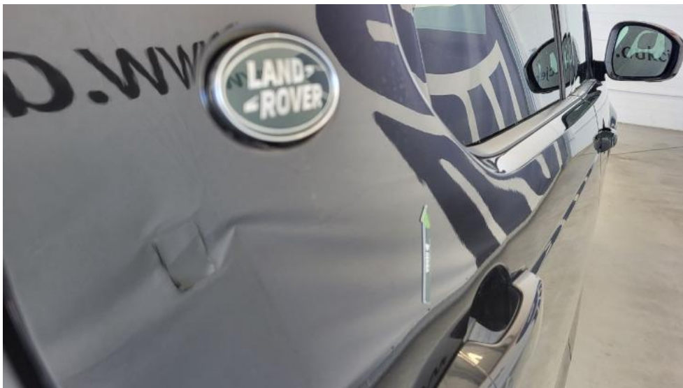
Fot. 59. Drzwi tylne P - Wgniecenie/odkształcenie 1
