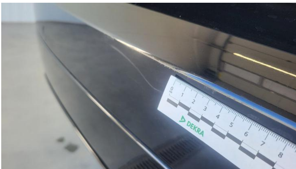
Fot. 66. Zderzak tylny - Rysa/odprysk 1
