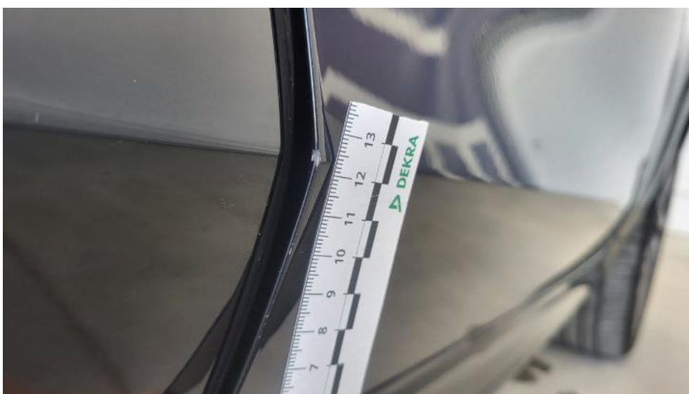
Fot. 56. Drzwi przednie P - Rysa/odprysk 1
