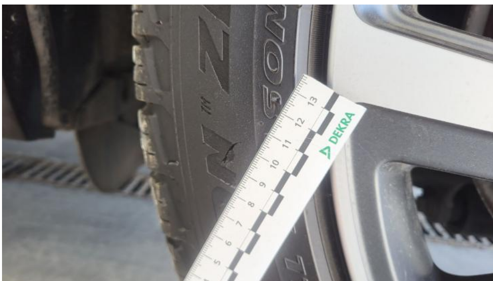
Fot. 70. Opona tylna L - Pęknięcie/rozerwanie 1
