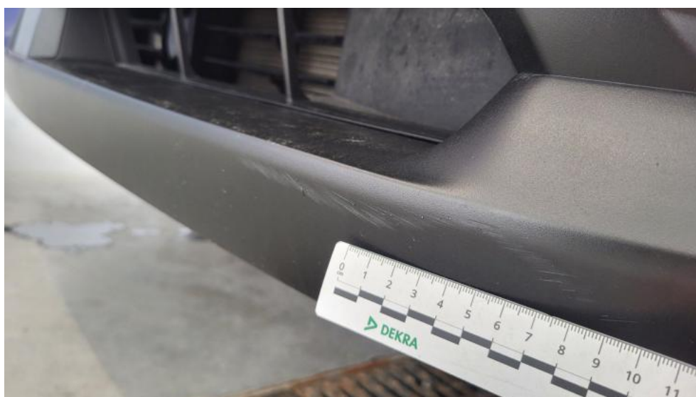
Fot. 40. Zderzak przedni cz dolna - Rysa/odprysk 1
