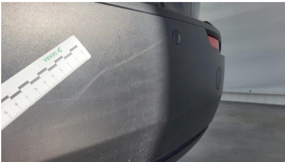
Fot. 51. Zderzak tylny - Rysa/odprysk 1
