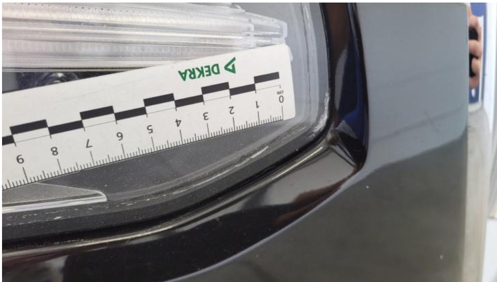
Photo 63. Reflektor P - Pęknięcie/rozerwanie 1
