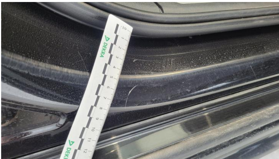
Photo 71. Próg P - Rysa/odprysk 1
