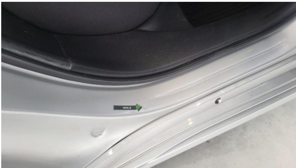
Fot. 47. Próg P - Wgniecenie/odkształcenie 1
