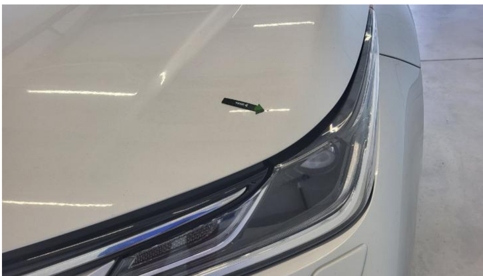
Fot. 38. Pokrywa komory silnika - Wgniecenie/odkształcenie 1
