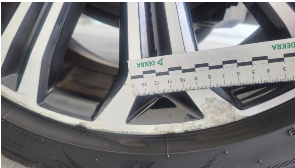
Fot. 61. Felga aluminiowa tylna L - Rysa/odprysk 1
