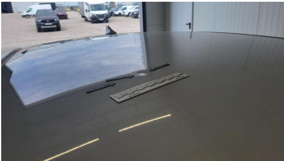
Fot. 57. Dach - Wgniecenie/odkształcenie 1
