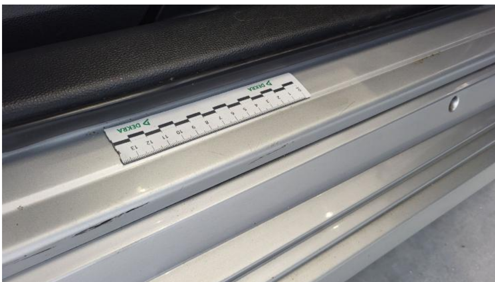
Fot. 46. Próg P - Rysa/odprysk 1
