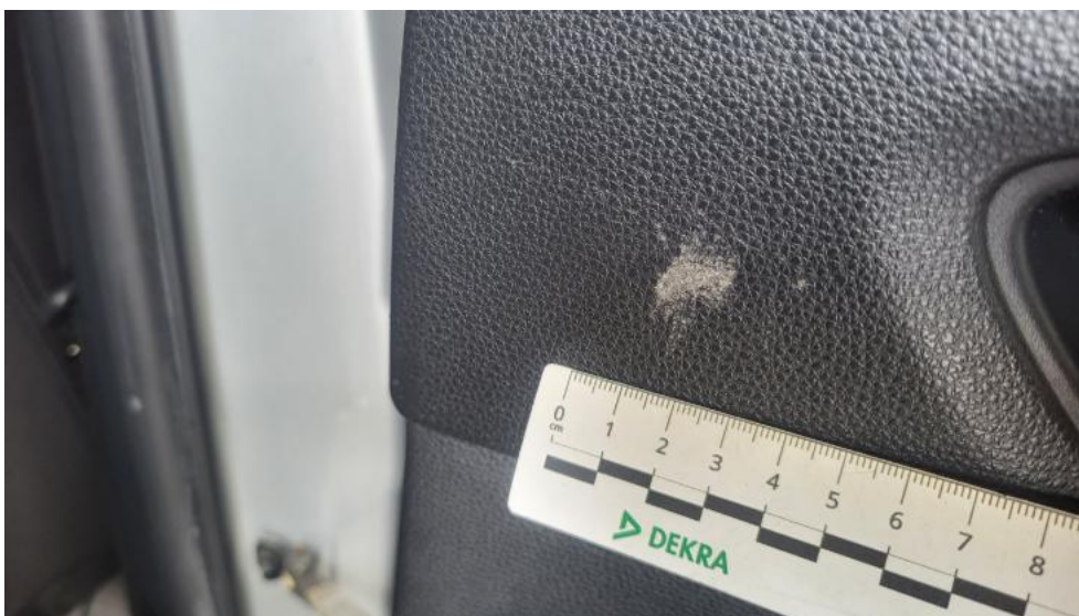
Fot. 72. Tapicerka drzwi tylnych P - Rysa/odprysk 1
