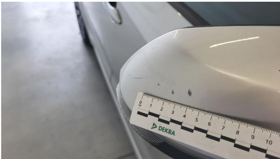
Fot. 45. Lusterko zew P - Rysa/odprysk 1
