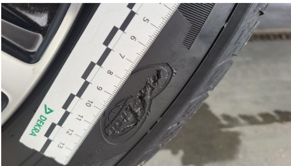
Fot. 85. Opona przednia L - Pęknięcie/rozerwanie 1
