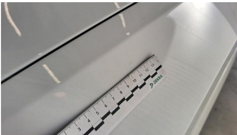
Fot. 82. Błotnik przedni L - Rysa/odprysk 1
