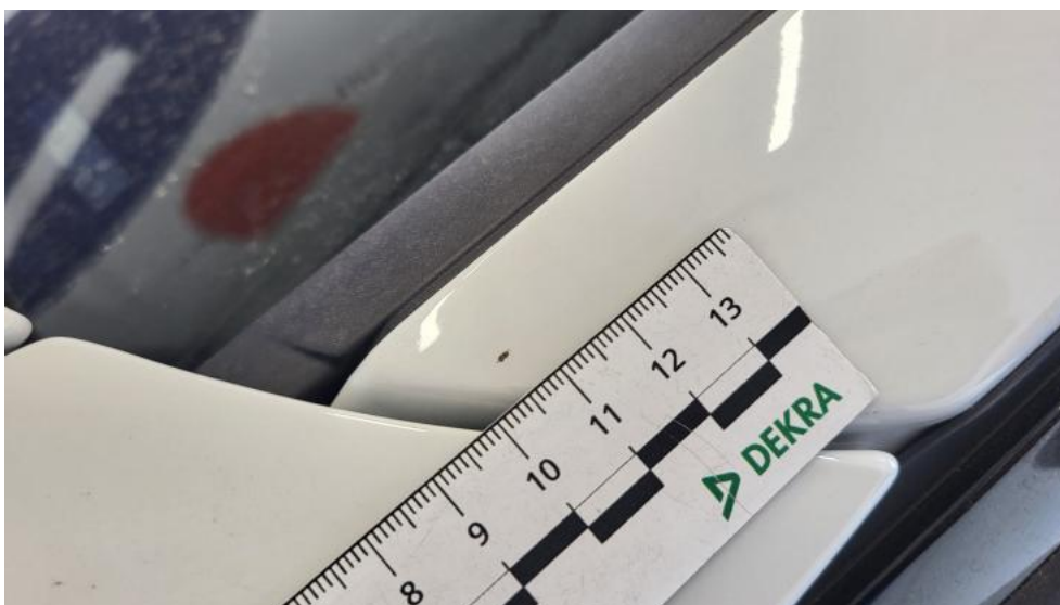
Photo 56. Słupek przedni L - Rysa/odprysk 1
