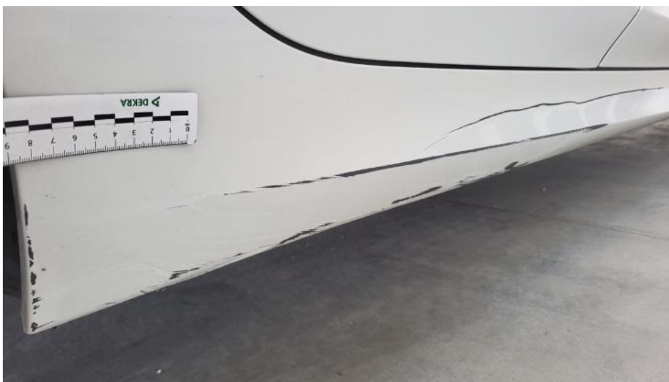
Photo 46. Próg P - Rysa/odprysk 2
