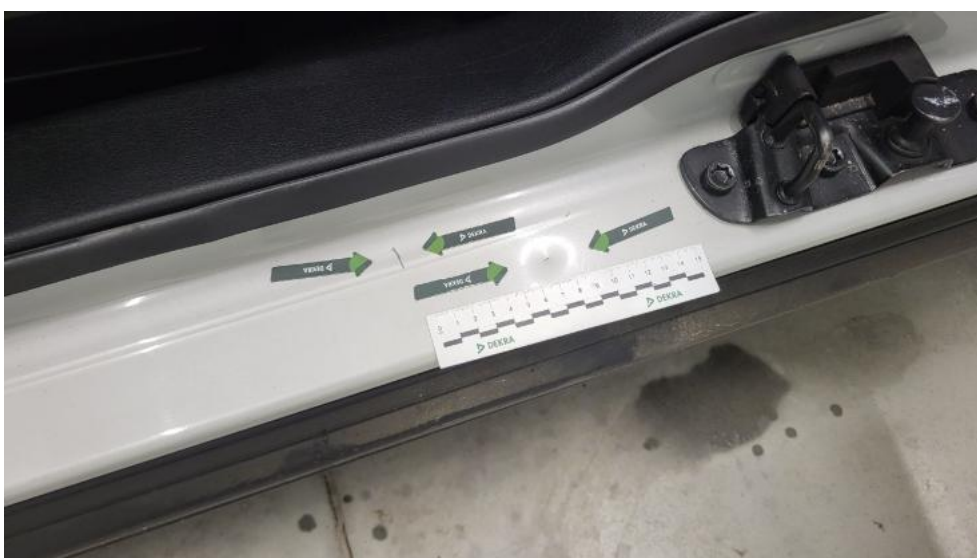
Photo 70. Próg L - Wgniecenie/odkształcenie 1
