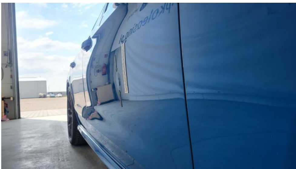
Photo 59. Drzwi przednie P - Wgniecenie/odkształcenie 1
