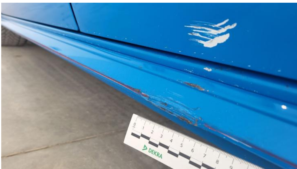
Photo 89. Próg L - Wgniecenie/odkształcenie 1
