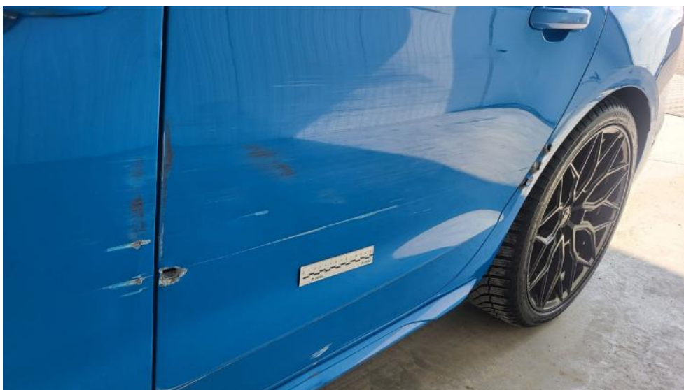
Photo 82. Drzwi tylne L - Rysa/odprysk 1
