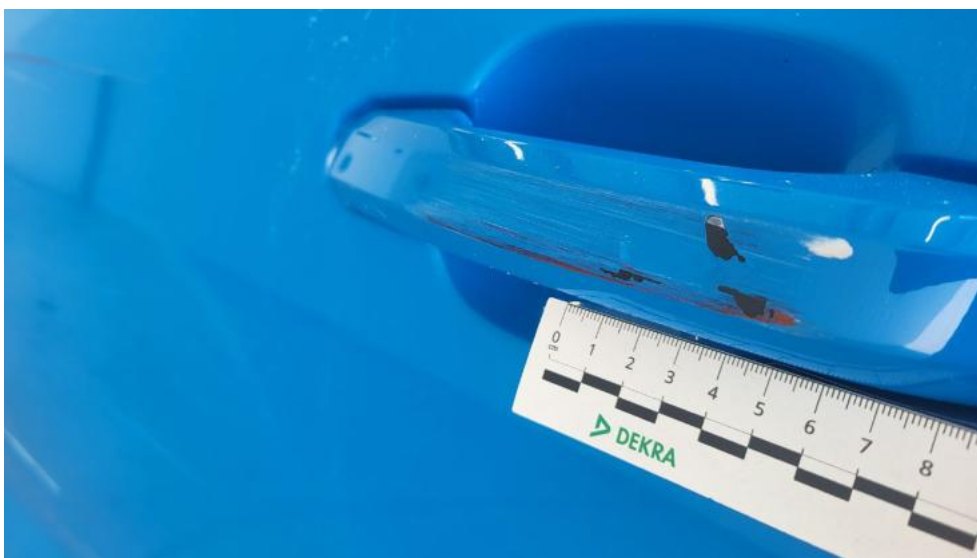
Photo 86. Klamka drzwi tyl L - Rysa/odprysk 1
