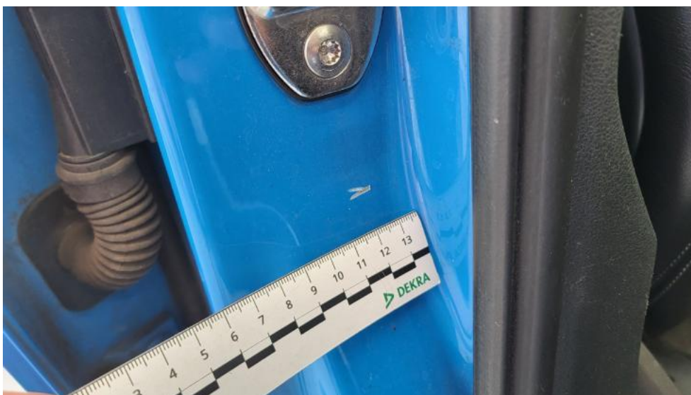
Photo 62. Słupek środkowy P - Rysa/odprysk 1
