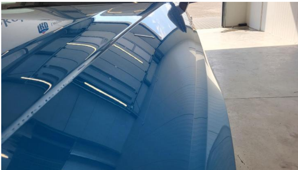
Photo 45. Pokrywa komory silnika - Wgniecenie/odkształcenie 2
