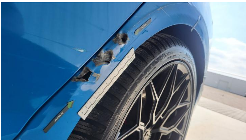
Photo 75. Błotnik tylny L / Ściana boczna L - Wgniecenie/odkształcenie 2
