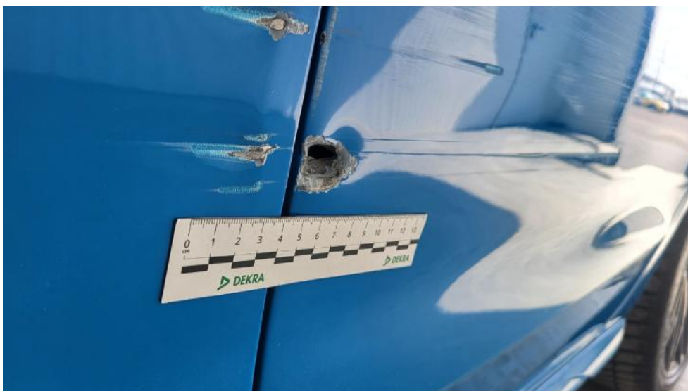
Photo 84. Drzwi tylne L - Pęknięcie/rozerwanie 1
