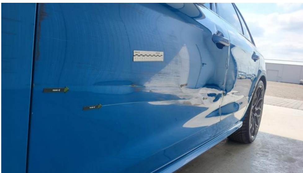
Photo 81. Drzwi przed L - Wgniecenie/odkształcenie 2
