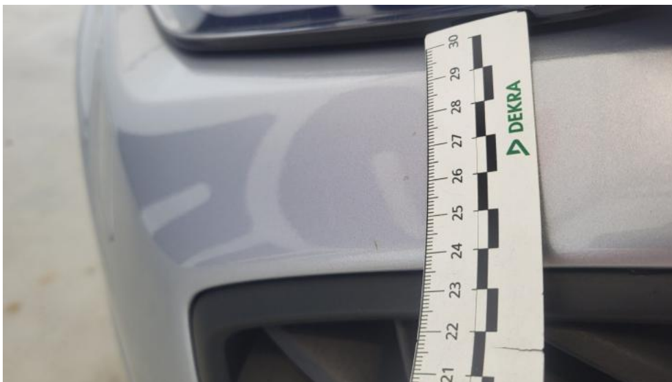
Fot. 41. Zderzak - Rysa/odprysk 1
