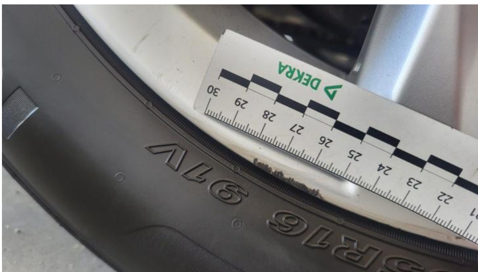
Fot. 42. Felga aluminiowa przednia P - Rysa/odprysk 1
