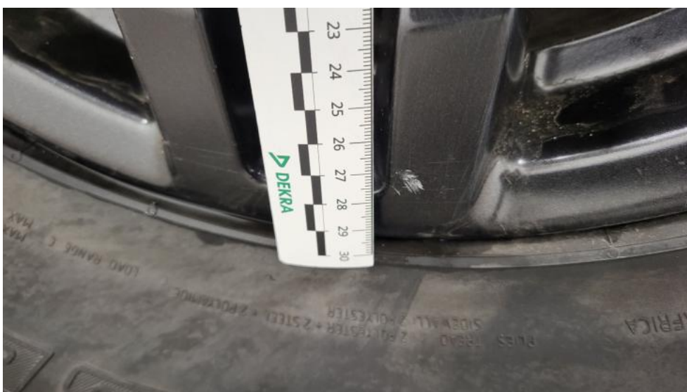
Photo 58. Felga aluminiowa tylna L - Rysa/odprysk 1
