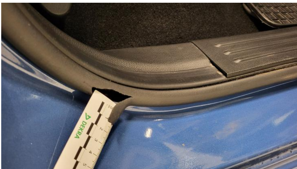
Photo 72. Uszczelka drzwi tylnych P - Pęknięcie/rozerwanie 1
