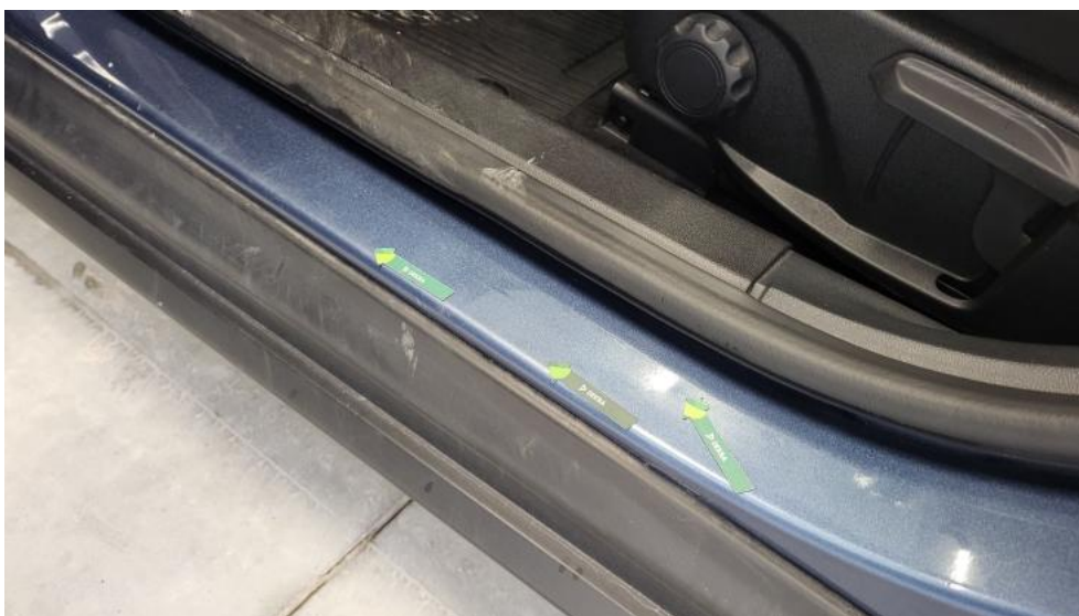
Fot. 62. Próg L - Wgniecenie/odkształcenie 1
