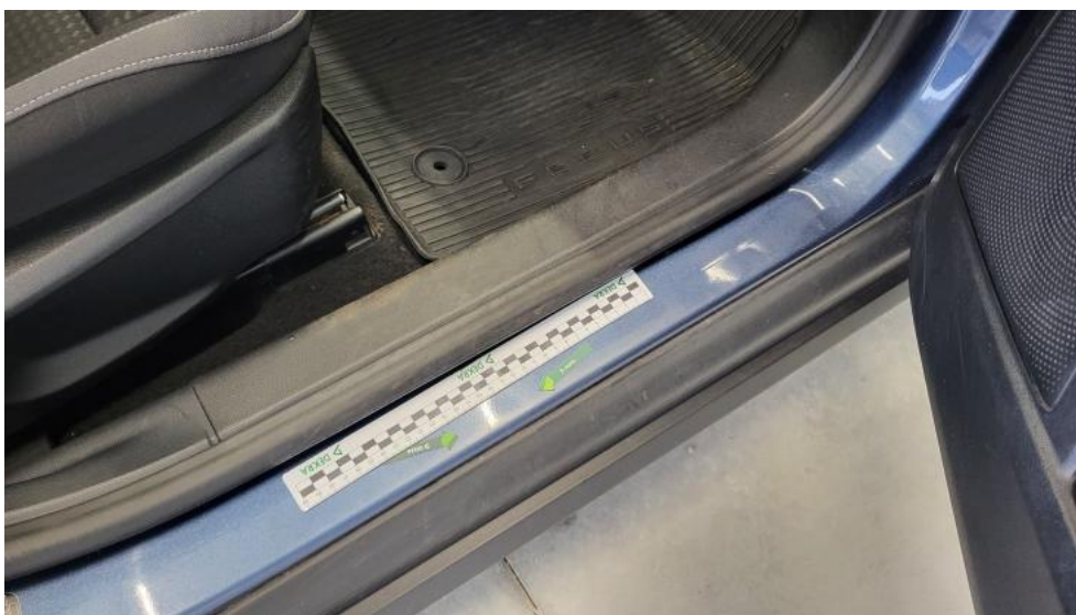
Fot. 48. Próg P - Wgniecenie/odkształcenie 1
