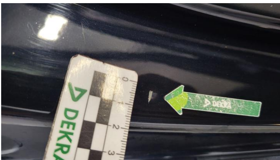
Photo 58. Próg P - Rysa/odprysk 1
