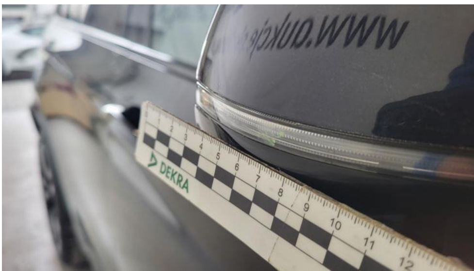
Photo 56. Lusterko zew P - Rysa/odprysk 1
