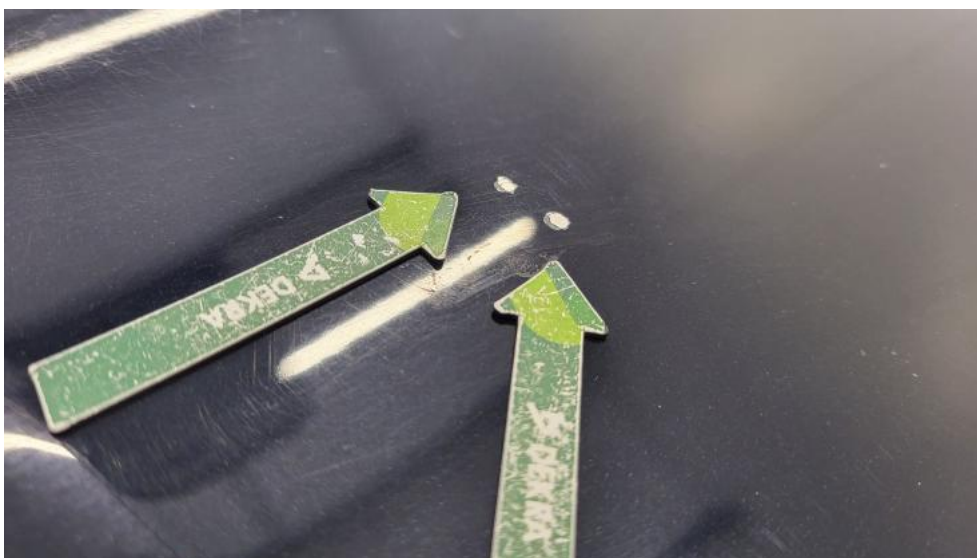
Photo 42. Pokrywa komory silnika - Rysa/odprysk 1
