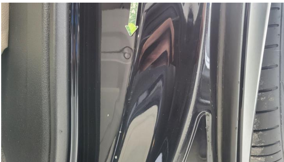
Photo 70. Błotnik tylny L / Ściana boczna L - Wgniecenie/odkształcenie 1
