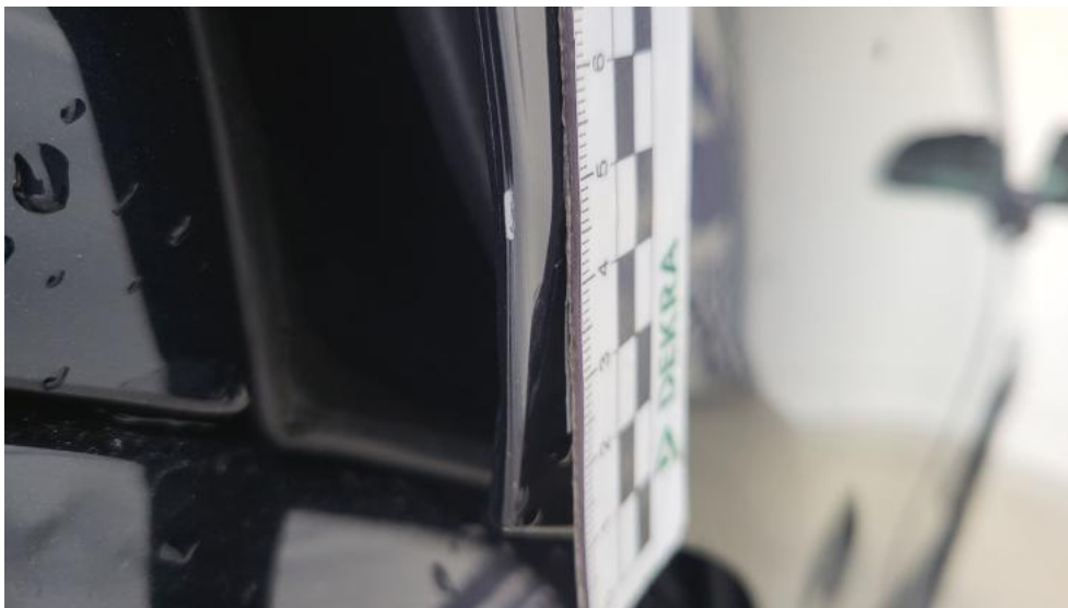
Photo 55. Drzwi tylne P - Rysa/odprysk 2
