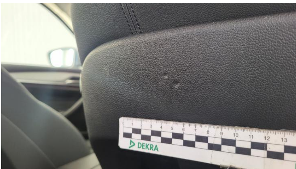
Fot. 43. Fotel prz. praw. - Wgniecenie/odkształcenie 1
