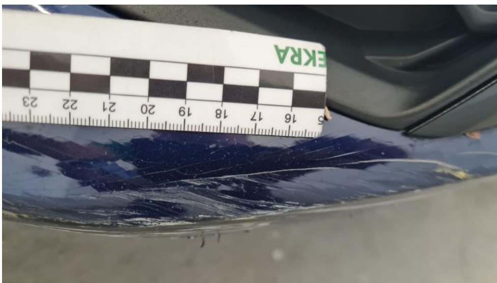
Fot. 38. Zderzak - Pęknięcie/rozerwanie 1
