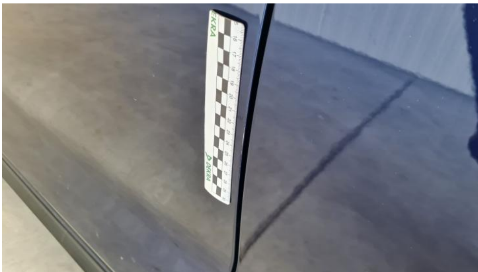
Fot. 55. Drzwi przed L - Rysa/odprysk 1
