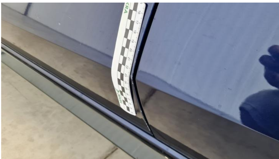
Fot. 56. Drzwi przed L - Rysa/odprysk 2
