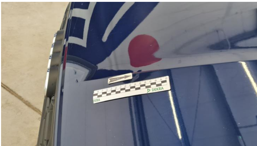
Fot. 35. Pokrywa komory silnika - Wgniecenie/odkształcenie 1
