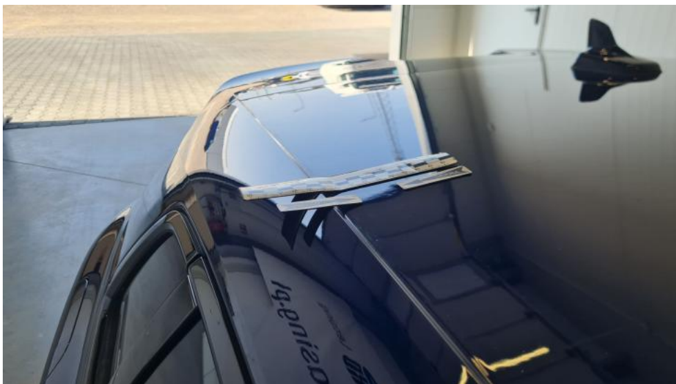
Fot. 53. Dach - Wgniecenie/odkształcenie 2
