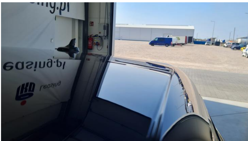
Fot. 54. Dach() - Wgniecenie/odkształcenie 3
