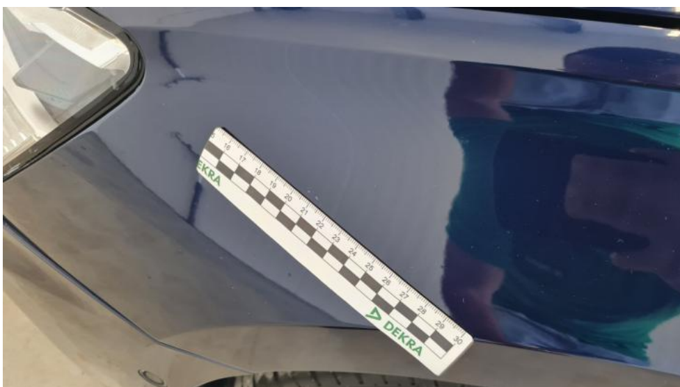
Fot. 57. Błotnik przedni L - Rysa/odprysk 1
