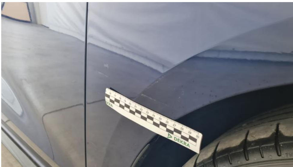
Fot. 39. Błotnik przedni P - Rysa/odprysk 1
