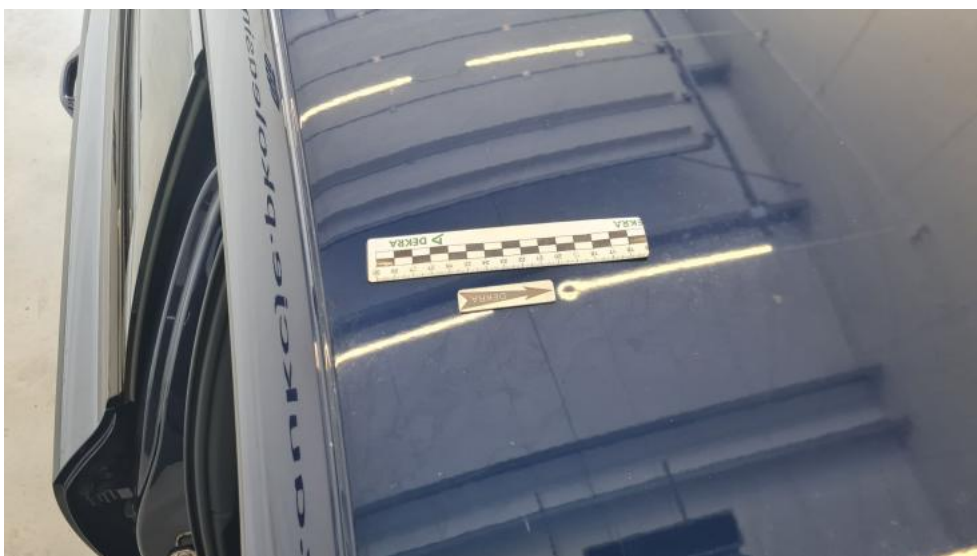
Fot. 52. Dach - Wgniecenie/odkształcenie 1
