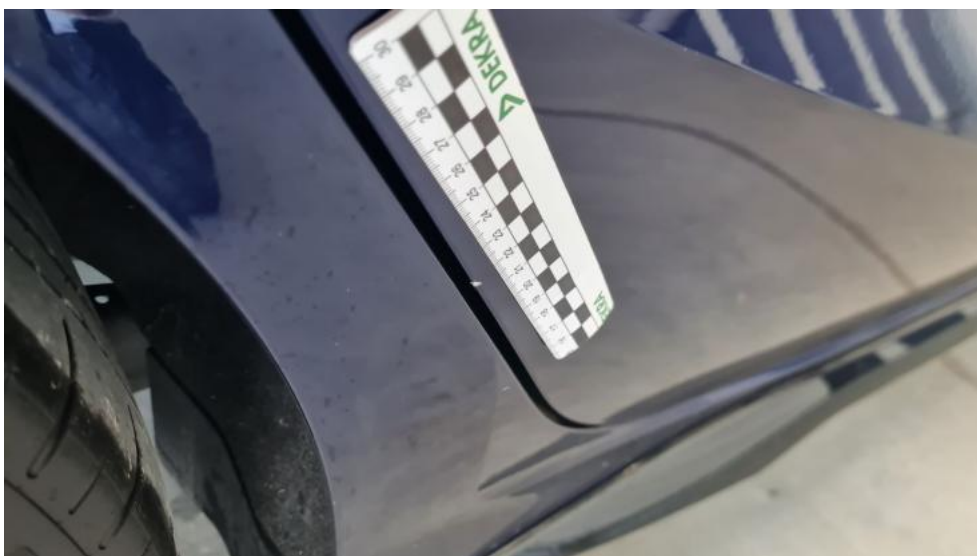
Fot. 42. Drzwi tylne P - Rysa/odprysk 1
