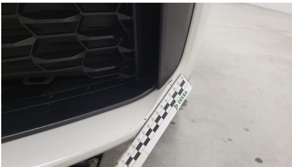
Fot. 44. Zderzak - Rysa/odprysk 2
