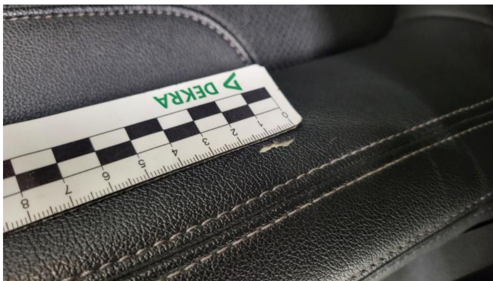
Fot. 47. Fotel prz. lew. - Pęknięcie/rozerwanie 1
