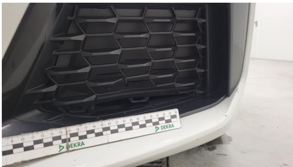
Fot. 40. Kratka zderzaka prz. - Pęknięcie/rozerwanie 1
