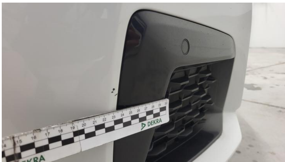
Fot. 45. Zderzak() - Rysa/odprysk 3
