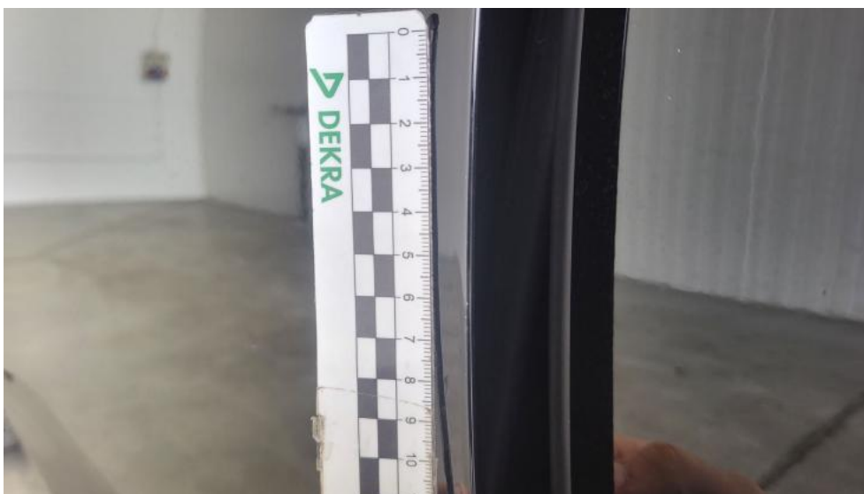
Fot. 53. Drzwi przed L - Rysa/odprysk 1
