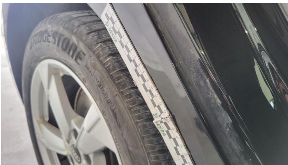
Fot. 47. Błotnik tylny P / Ściana boczna P - Rysa/odprysk 1
