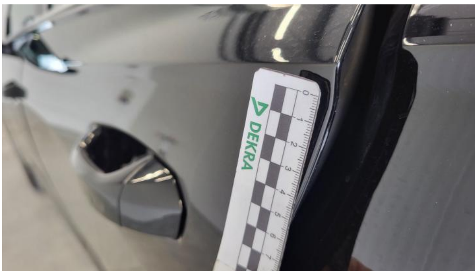
Fot. 54. Drzwi tylne L - Rysa/odprysk 1
