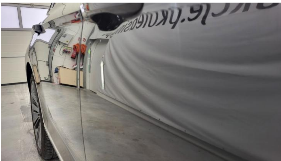
Photo 49. Drzwi przednie P - Wgniecenie/odkształcenie 1
