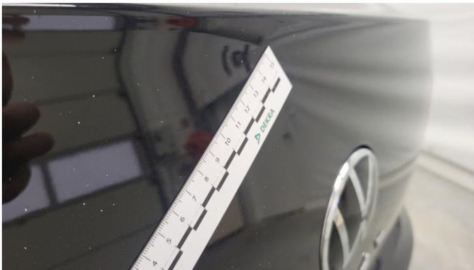
Photo 57. Pokrywy bagażnika - Rysa/odprysk 1
