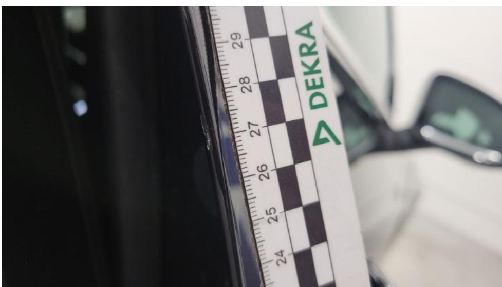
Fot. 44. Drzwi przednie P - Rysa/odprysk 1
