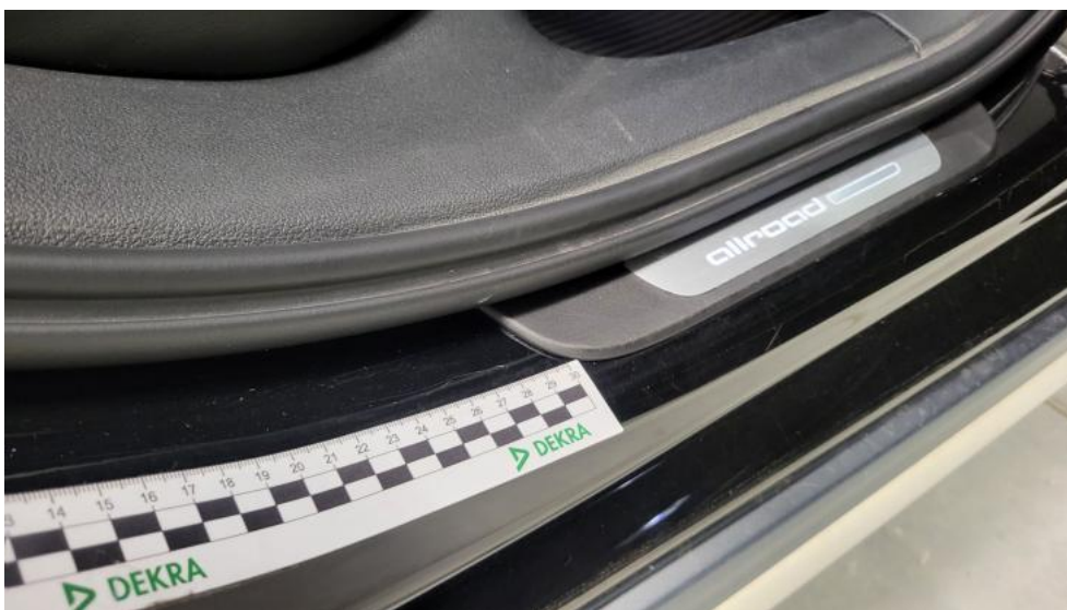
Fot. 49. Próg P - Rysa/odprysk 1
