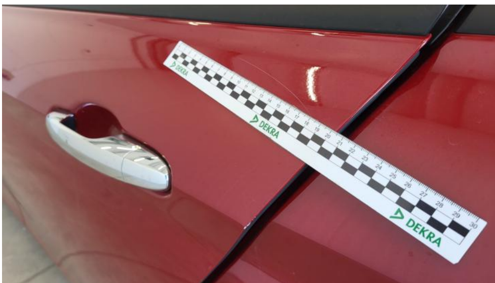
Fot. 69. Drzwi tylne L - Rysa/odprysk 1
