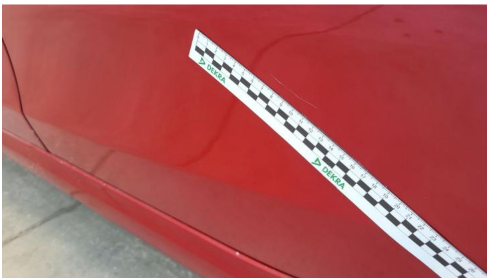
Fot. 70. Drzwi tylne L - Rysa/odprysk 2
