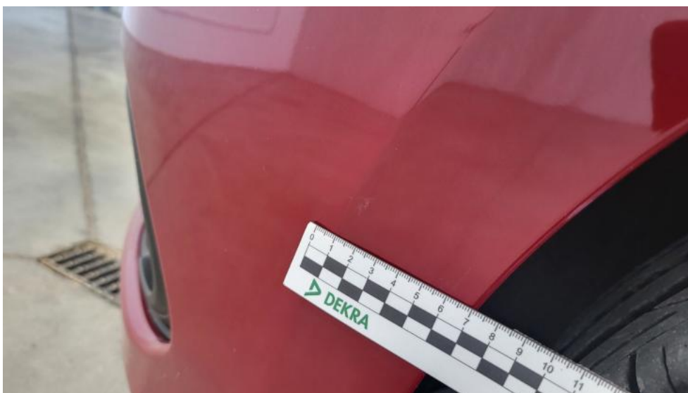
Fot. 44. Zderzak - Rysa/odprysk 1
