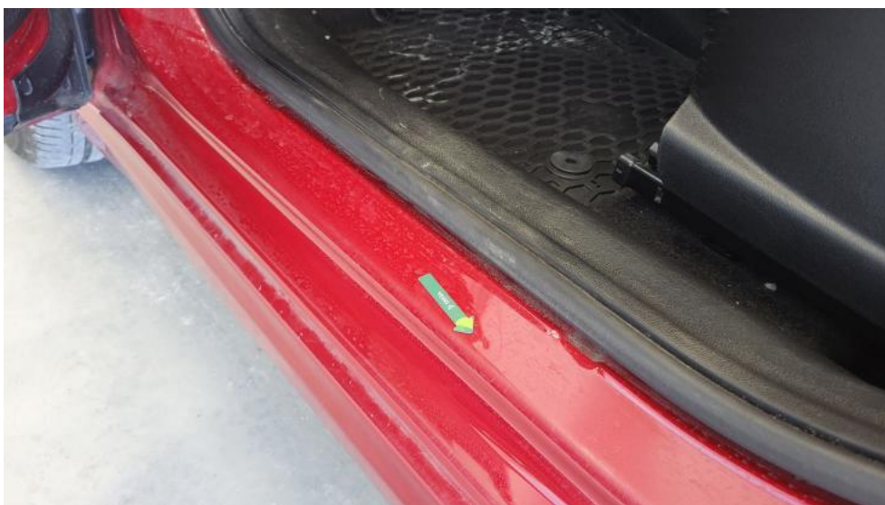
Fot. 74. Próg L - Wgniecenie/odkształcenie 1
