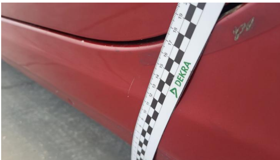
Fot. 73. Próg L - Rysa/odprysk 2
