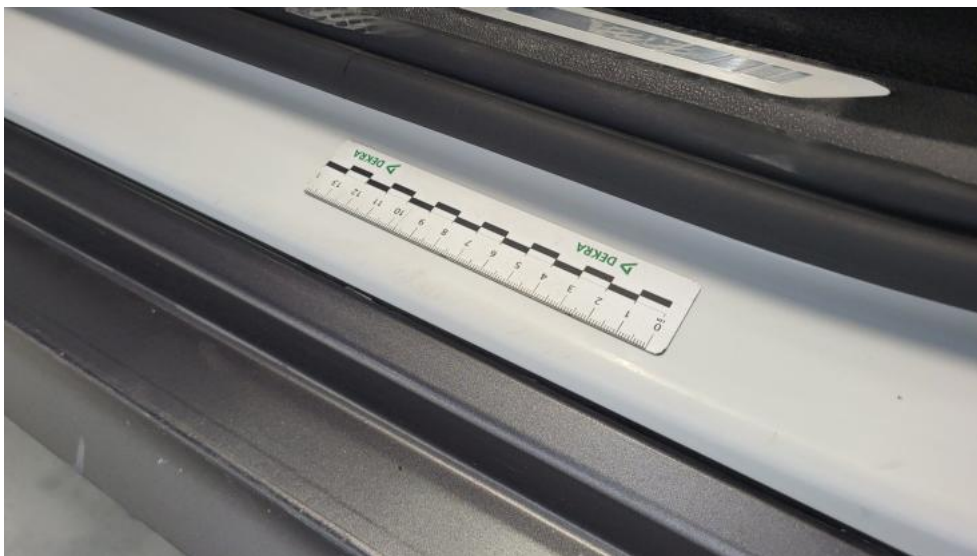
Fot. 63. Próg L - Rysa/odprysk 1
