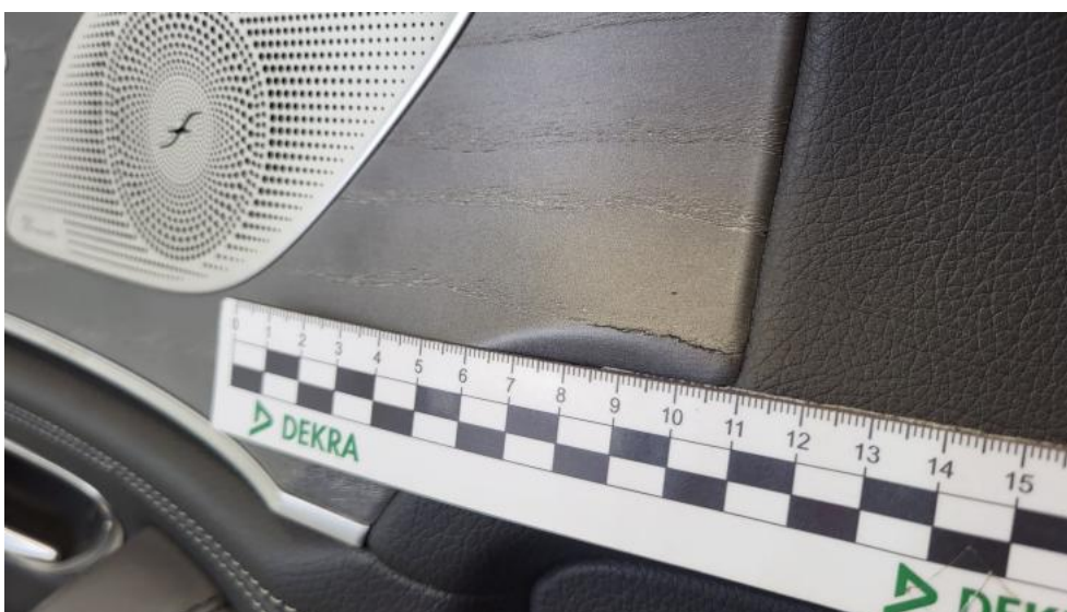
Fot. 84. Tapicerka drzwi przednich L - Pęknięcie/rozerwanie 1
