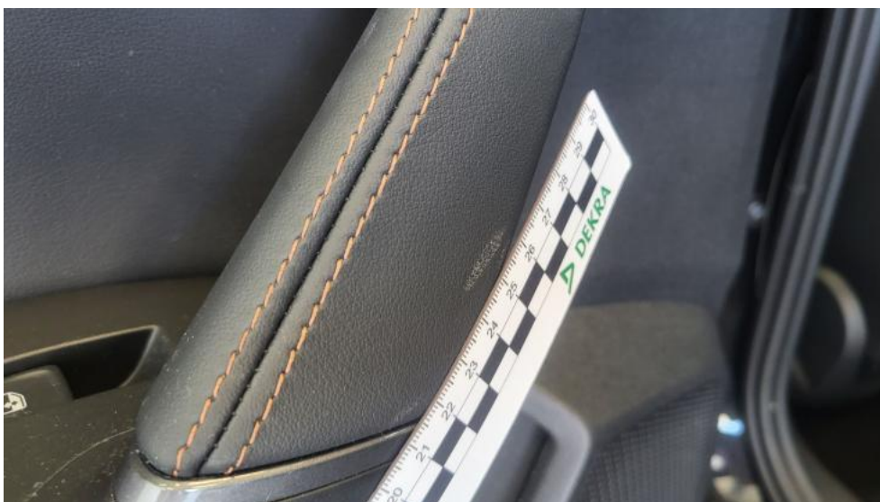
Photo 52. Uchwyt drzwi tyl L - Rysa/odprysk 1
