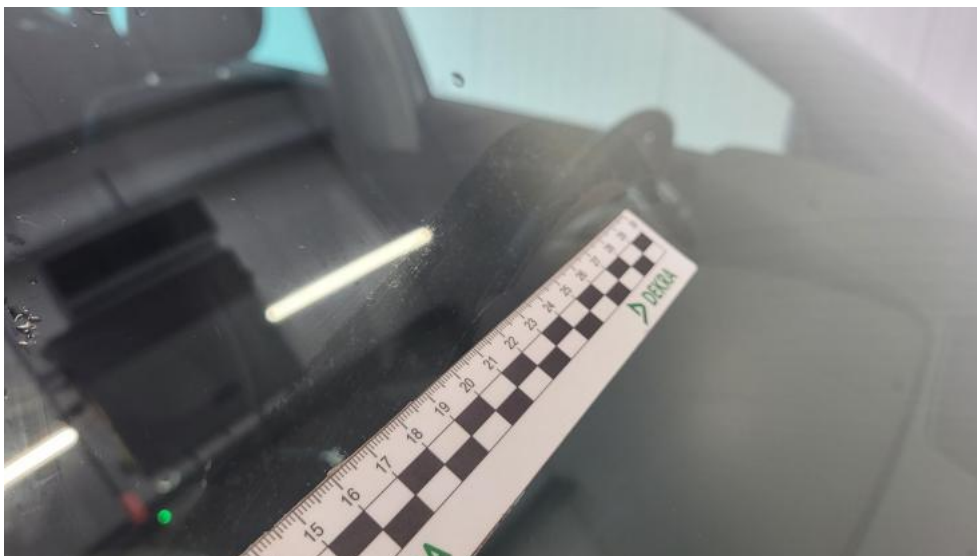
Fot. 38. Szyba czołowa - Rysa/odprysk 1
