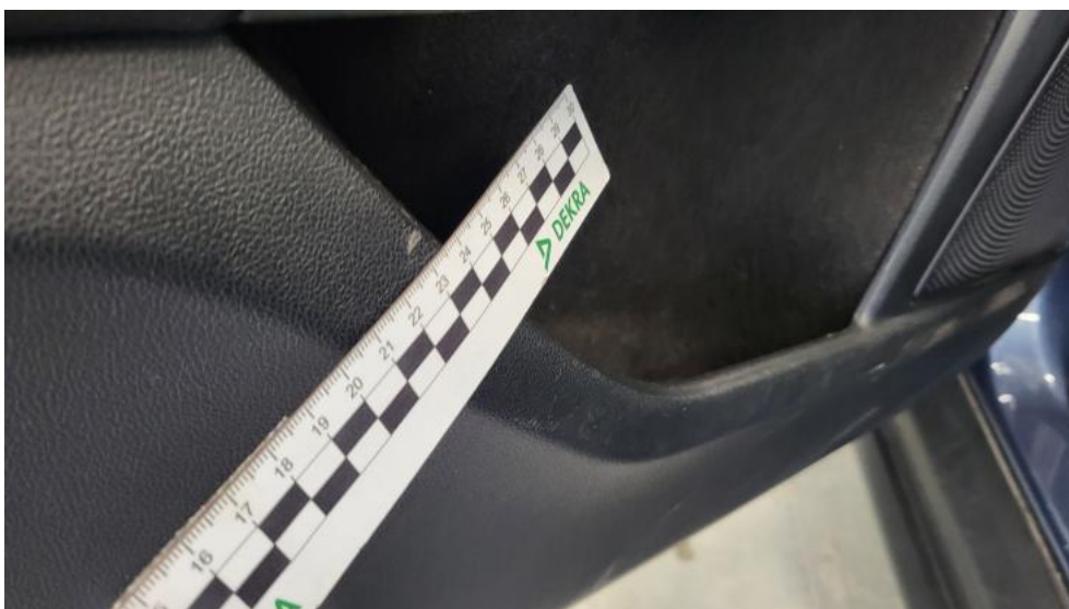
Photo 68. Tapicerka drzwi przednich L - Rysa/odprysk 1
