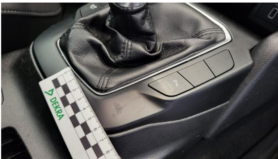
Fot. 58. Konsola tunelu śr. - Rysa/odprysk 1
