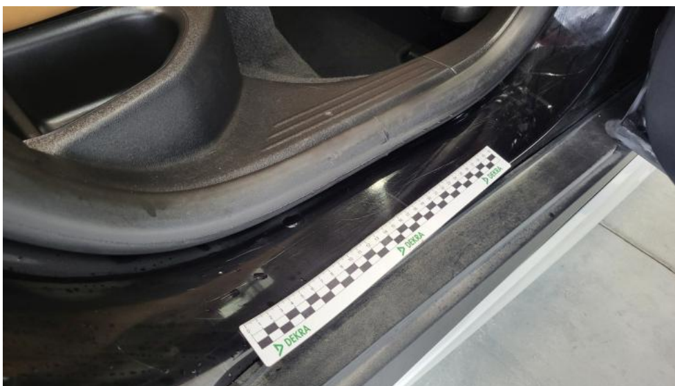
Fot. 45. Próg P - Rysa/odprysk 1
