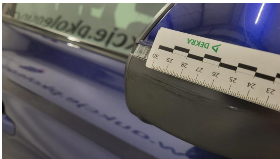
Fot. 50. Lusterko zew P - Rysa/odprysk 1
