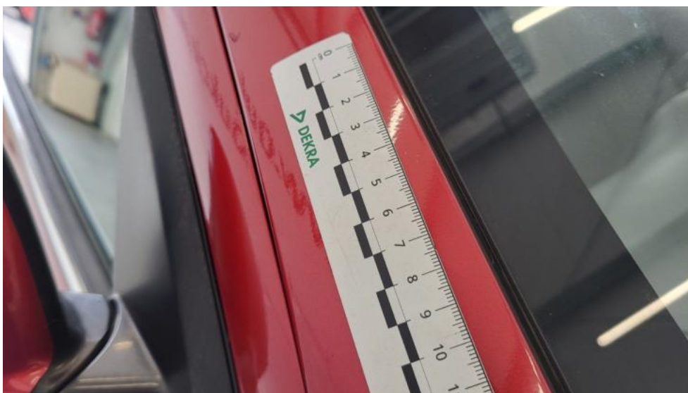
Fot. 78. Słupek przedni P - Rysa/odprysk 1
