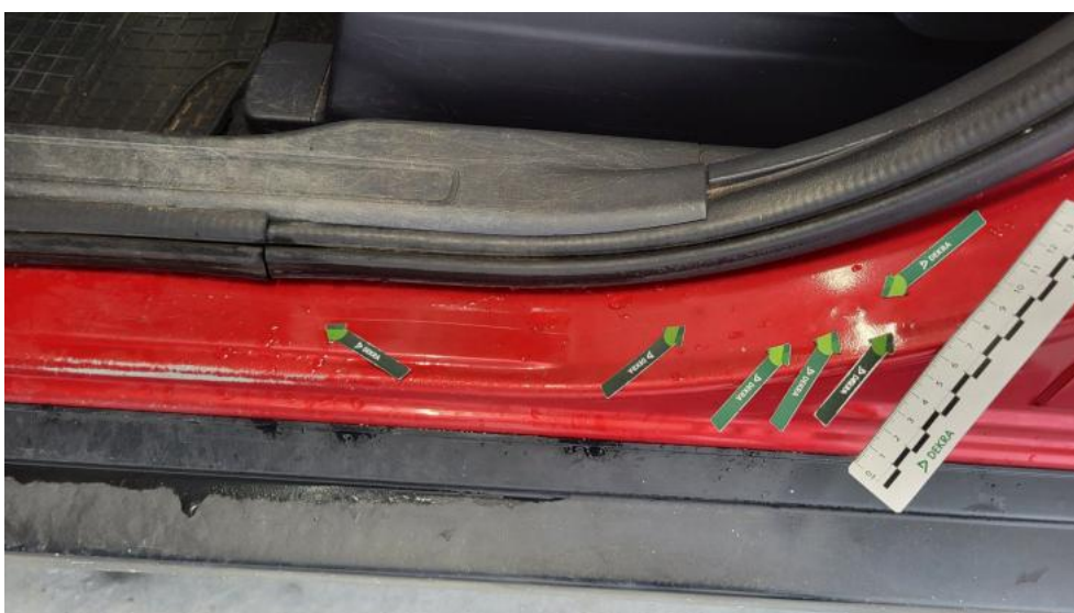
Fot. 118. Próg L - Wgniecenie/odkształcenie 1
