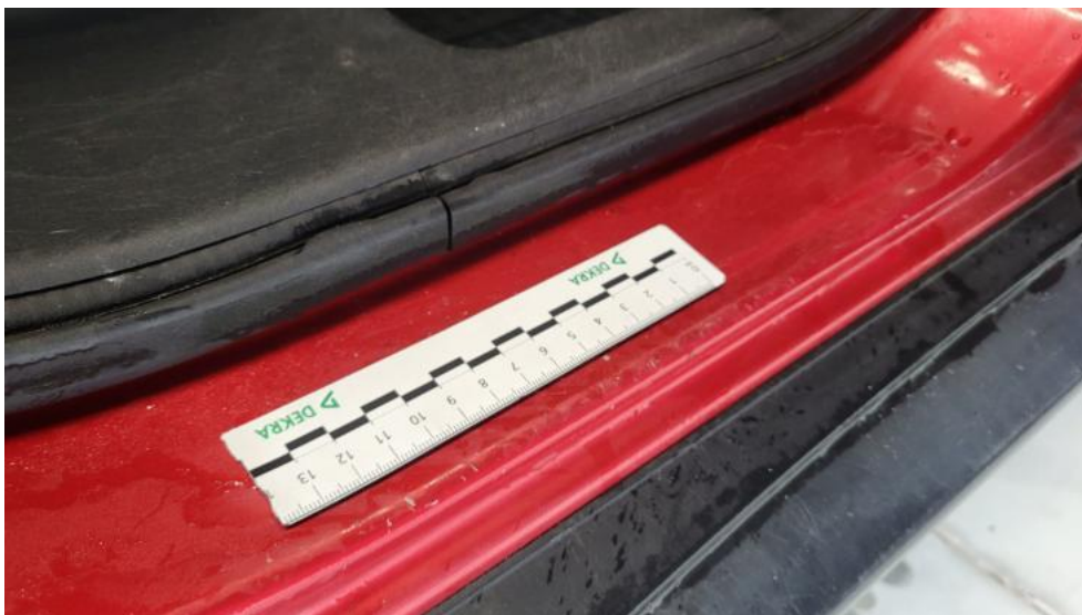
Fot. 77. Próg P - Rysa/odprysk 2
