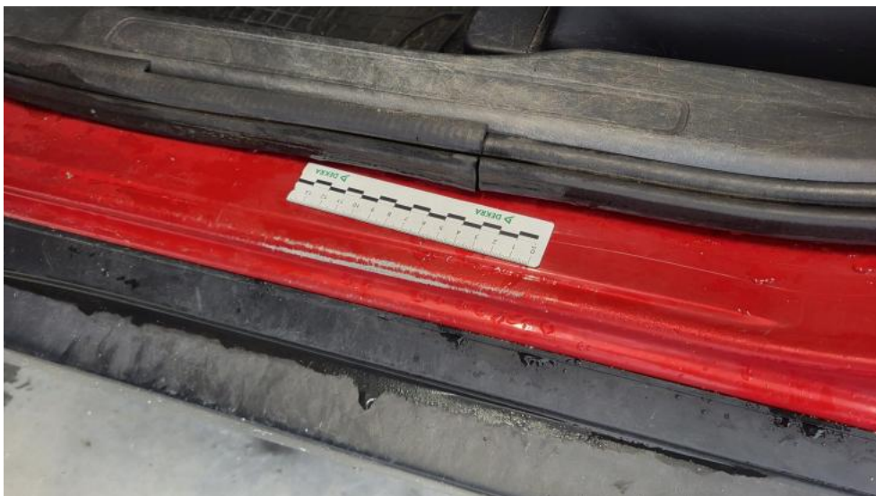
Fot. 117. Próg L - Rysa/odprysk 2
