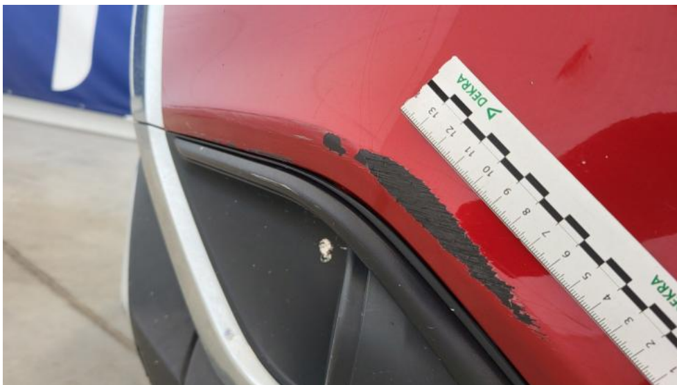
Fot. 55. Zderzak przedni cz L - Rysa/odprysk 2
