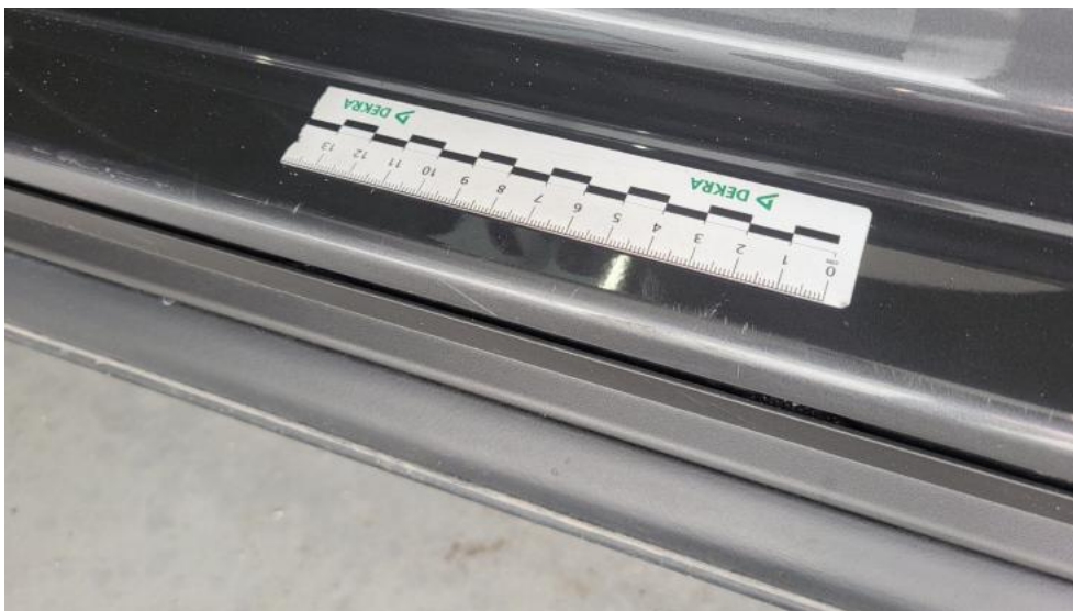
Photo 57. Próg L - Rysa/odprysk 1
