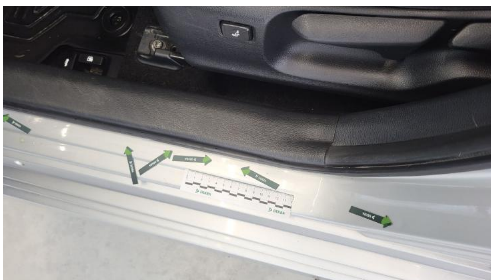
Photo 64. Próg L - Wgniecenie/odkształcenie 1
