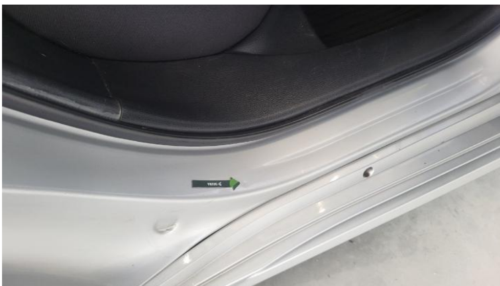
Photo 47. Próg P - Wgniecenie/odkształcenie 1
