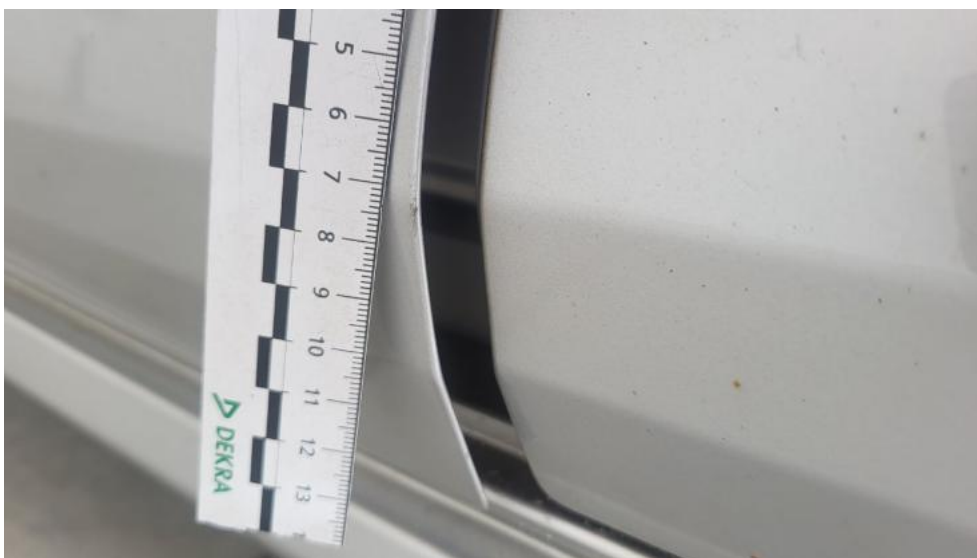
Photo 62. Drzwi przed L - Rysa/odprysk 1
