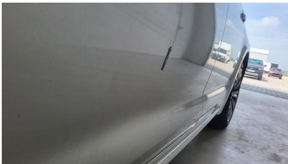
Photo 63. Drzwi przed L - Wgniecenie/odkształcenie 1
