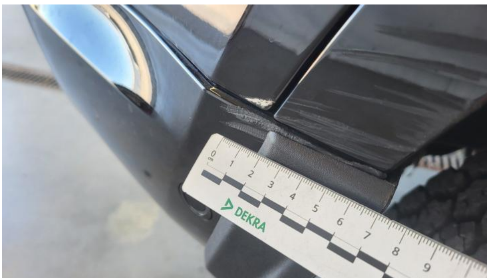
Fot. 56. Zderzak tylny cz P - Rysa/odprysk 1
