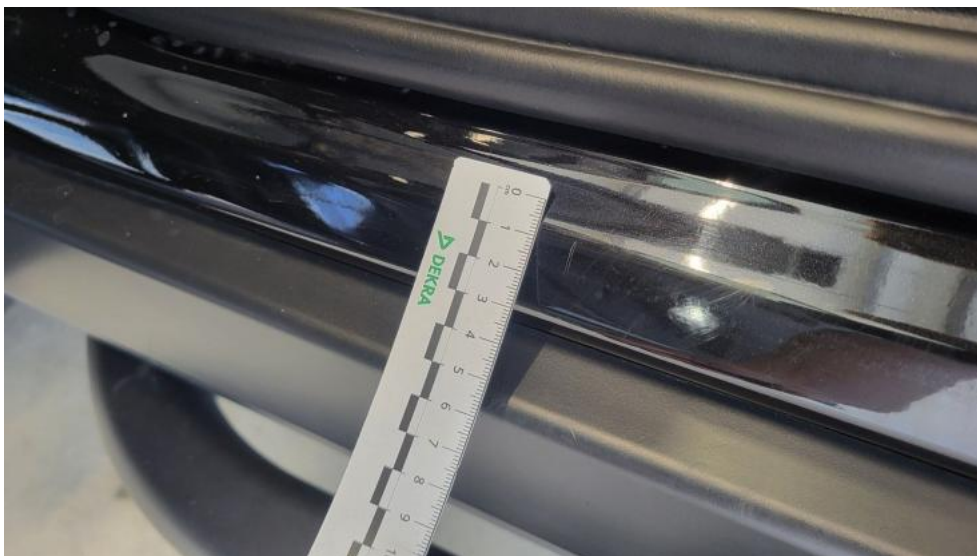
Fot. 61. Próg L - Rysa/odprysk 1
