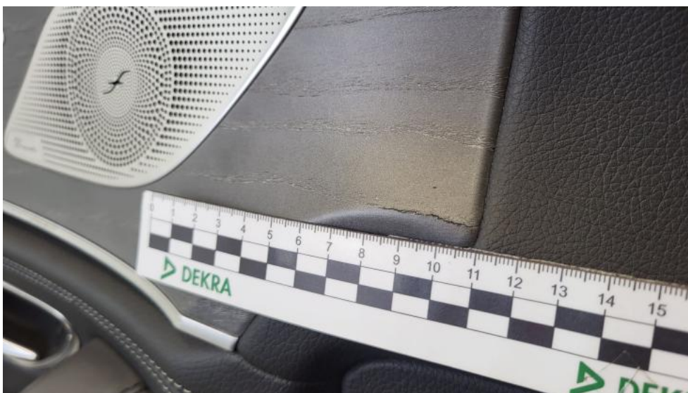
Photo 84. Tapicerka drzwi przednich L - Pęknięcie/rozerwanie 1
