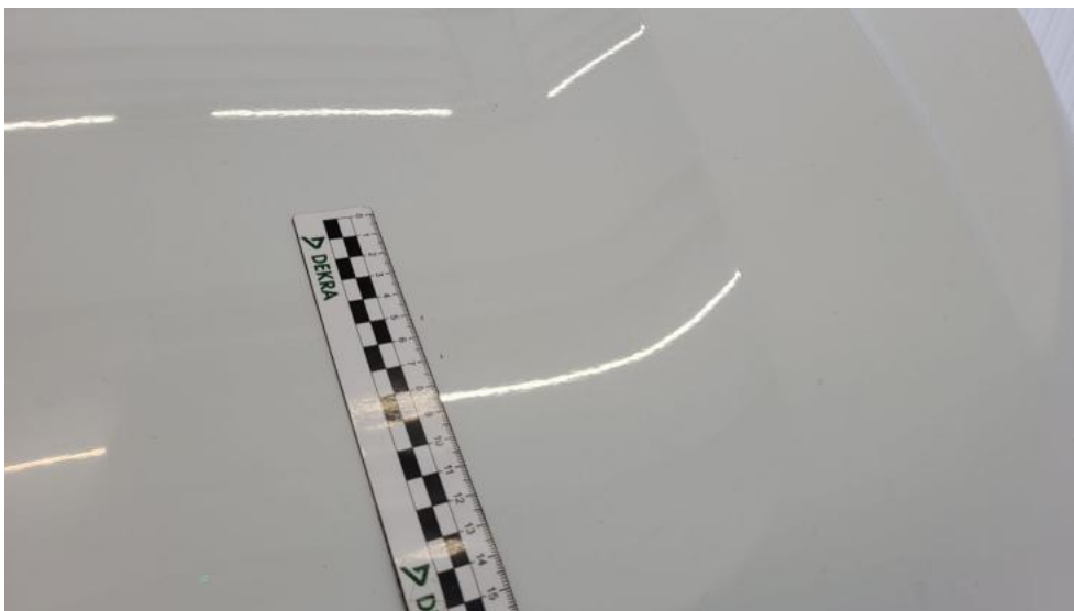
Fot. 34. Pokrywa komory silnika - Rysa/odprysk 1
