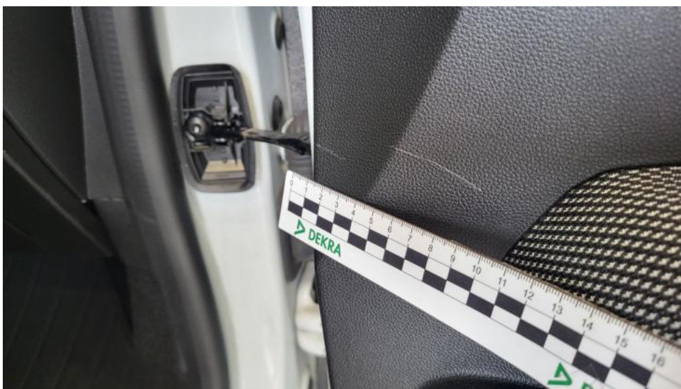
Fot. 44. Tapicerka drzwi przednich P - Rysa/odprysk 1
