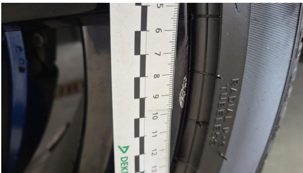
Photo 64. Felga Aluminiowa przednia L - Rysa/odprysk 1
