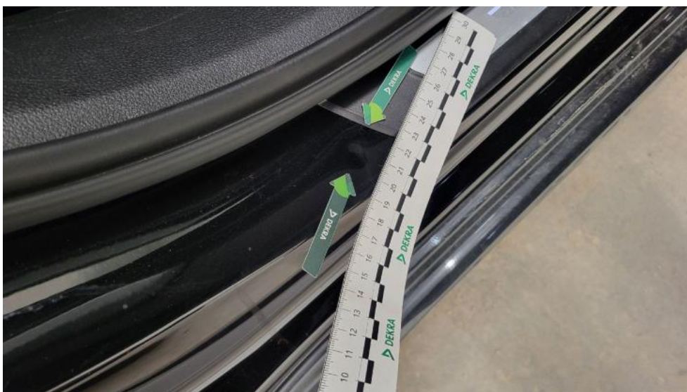
Photo 52. Próg P - Wgniecenie/odkształcenie 1
