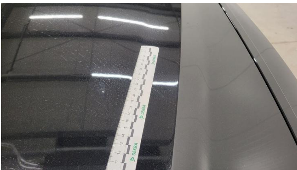
Photo 44. Pokrywa komory silnika - Rysa/odprysk 2
