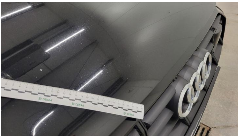
Photo 43. Pokrywa komory silnika - Rysa/odprysk 1
