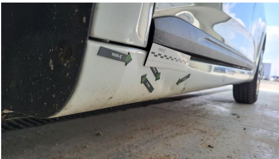
Fot. 74. Próg L - Wgniecenie/odkształcenie 2
