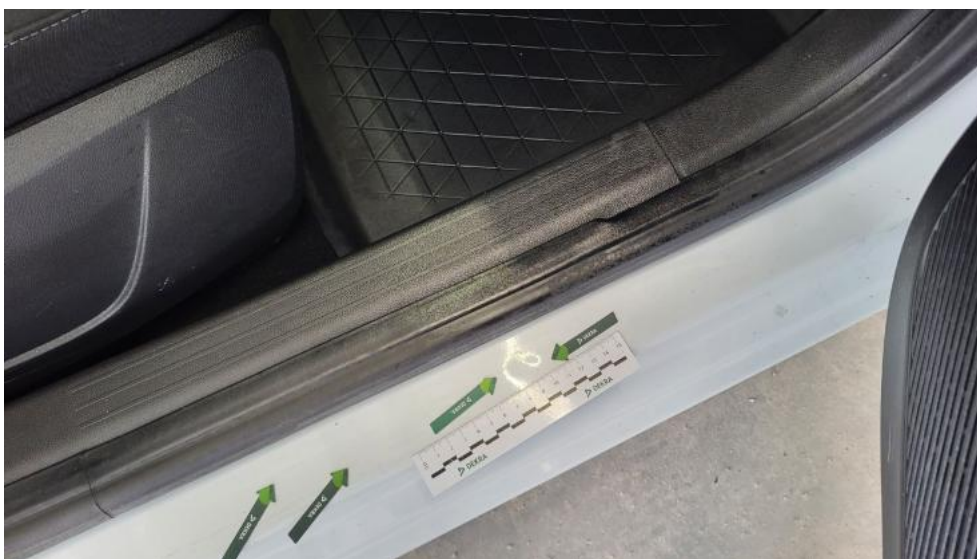
Fot. 61. Próg P - Wgniecenie/odkształcenie 2
