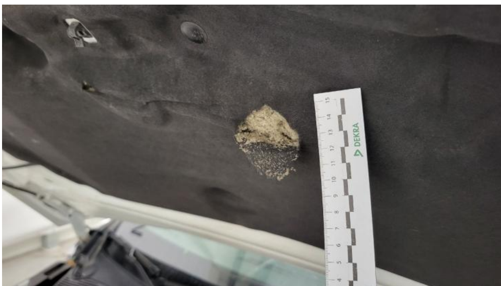
Fot. 41. Wykładzina pokrywy komory silnika - Pęknięcie/rozerwanie 1
