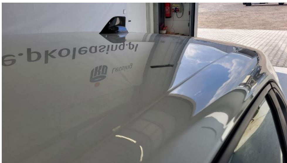
Fot. 65. Dach - Wgniecenie/odkształcenie 1
