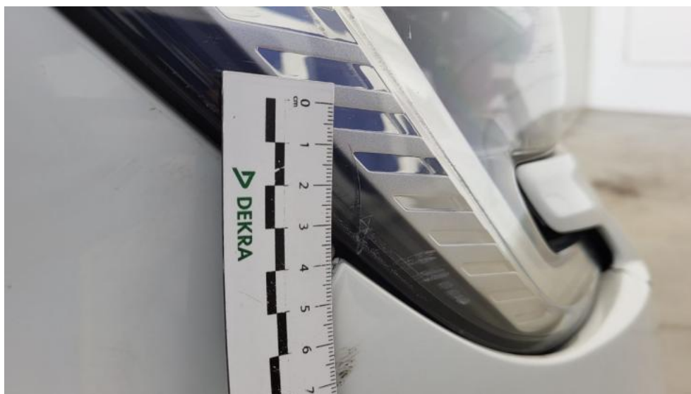
Fot. 53. Reflektor P - Pęknięcie/rozerwanie 1
