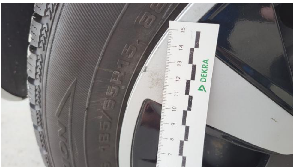
Fot. 62. Kołpak tylny P - Rysa/odprysk 1
