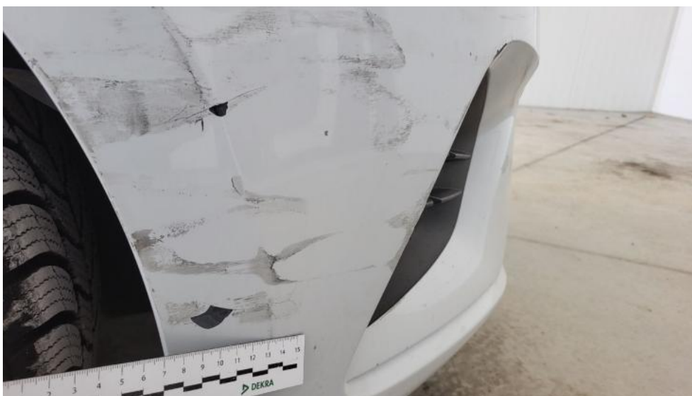
Fot. 47. Zderzak() - Pęknięcie/rozerwanie 3
