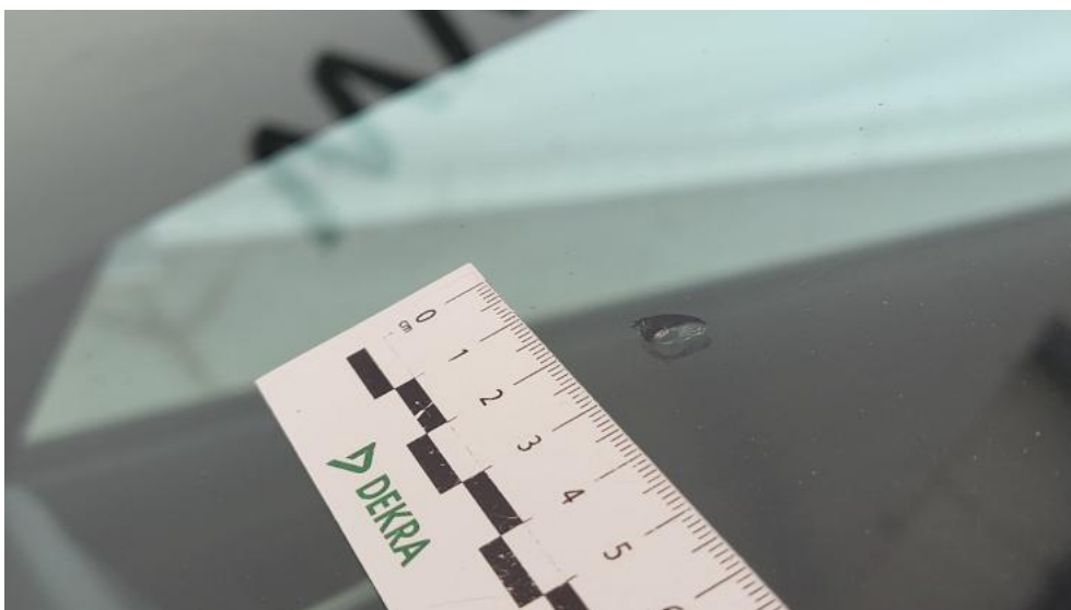
Fot. 40. Szyba czołowa - Pęknięcie/rozerwanie 2
