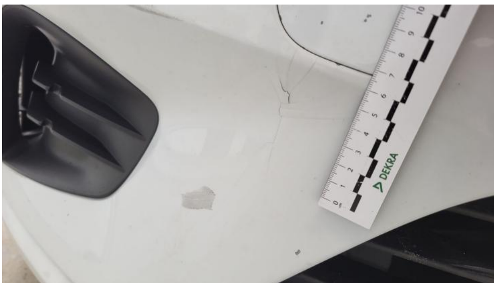
Fot. 45. Zderzak - Pęknięcie/rozerwanie 1
