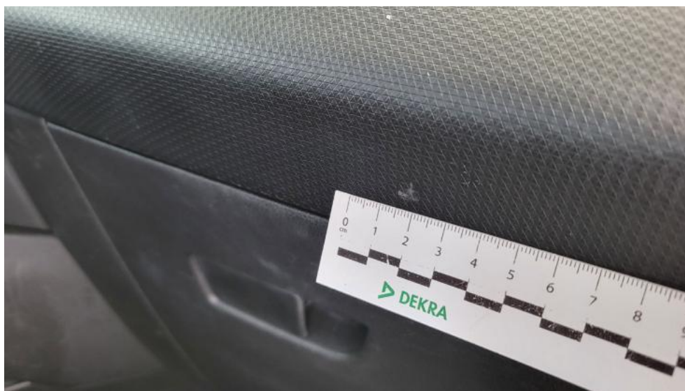
Fot. 75. Deska rozdzielcza - Rysa/odprysk 1
