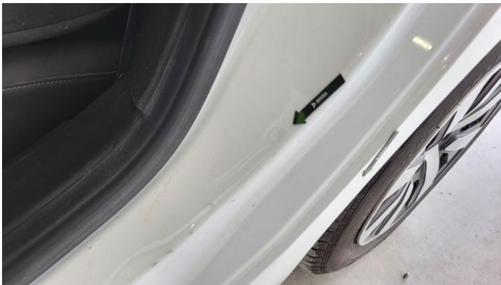
Fot. 67. Błotnik tylny L / Ściana boczna L - Wgniecenie/odkształcenie 1
