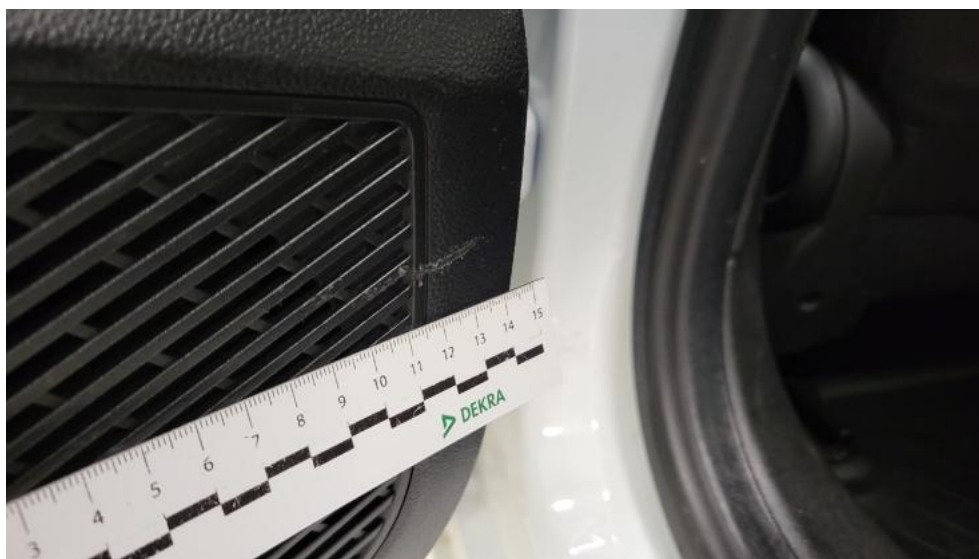
Fot. 81. Tapicerka drzwi tylnych L - Rysa/odprysk 1
