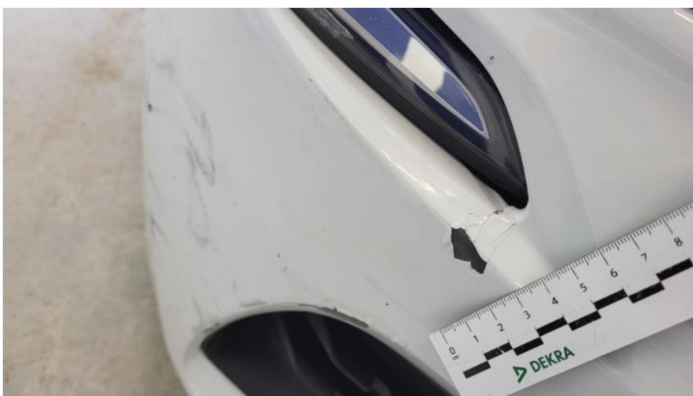
Fot. 46. Zderzak - Pęknięcie/rozerwanie 2
