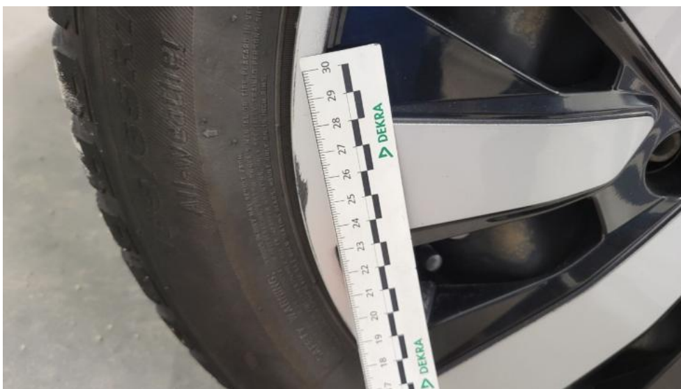
Fot. 55. Kołpak tylny P - Rysa/odprysk 1
