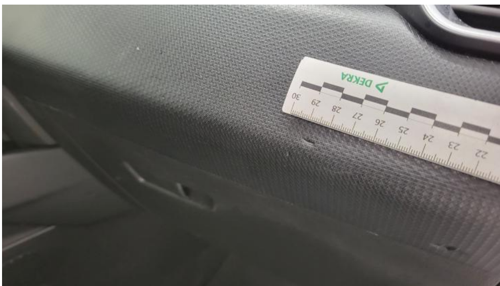
Fot. 65. Deska rozdzielcza - Wgniecenie/odkształcenie 1
