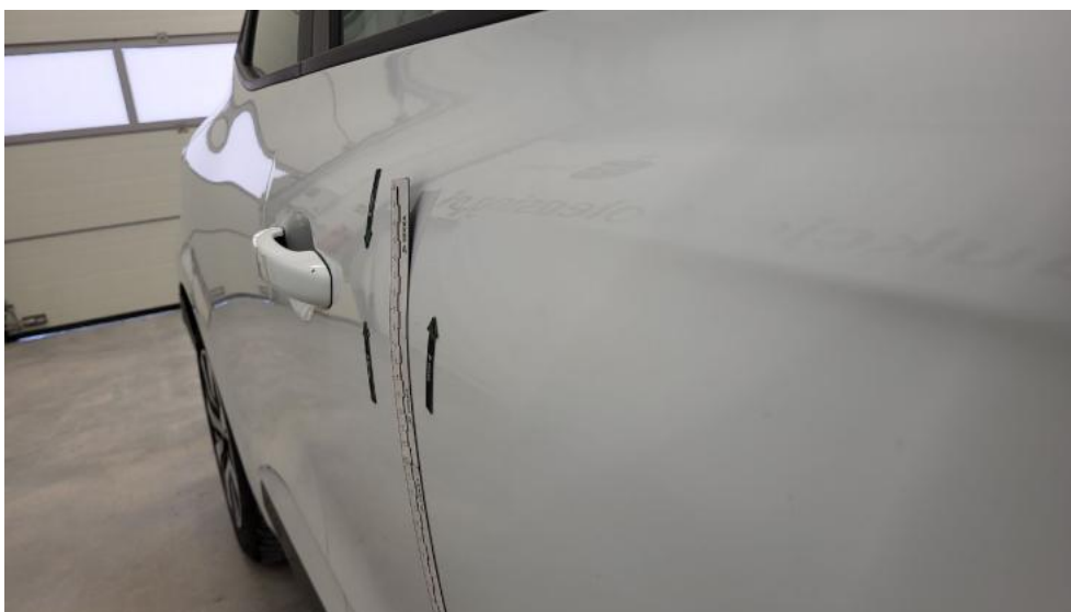
Fot. 46. Drzwi przednie P - Wgniecenie/odkształcenie 1
