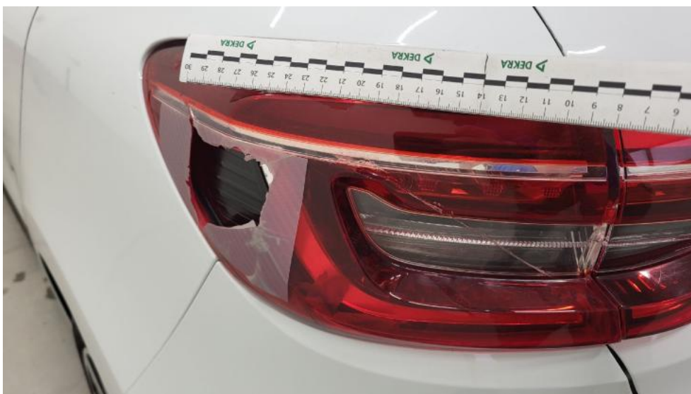
Fot. 60. Lampa tylna zew L - Pęknięcie/rozerwanie 1
