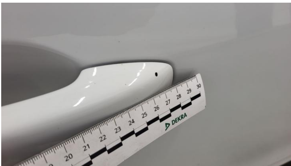
Fot. 51. Klamka drzwi prz P - Rysa/odprysk 1
