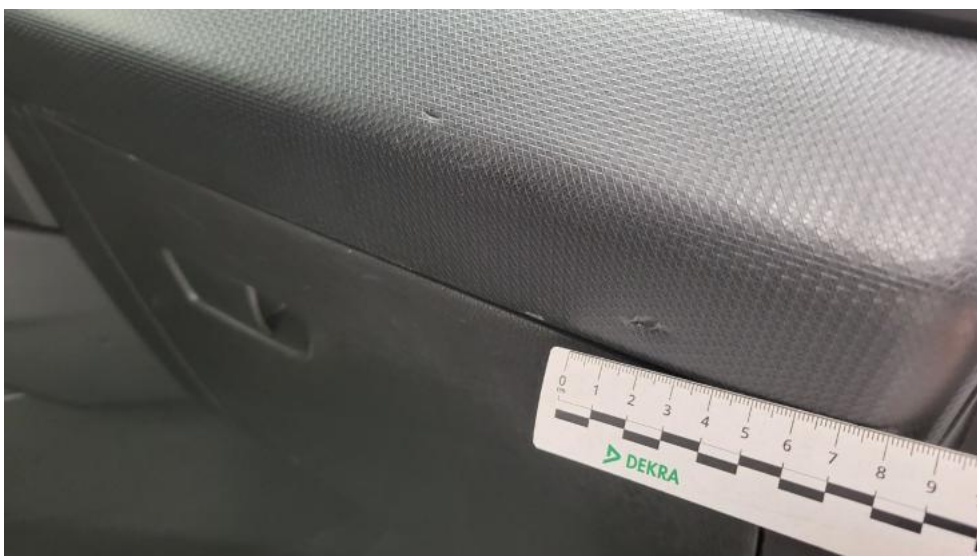
Fot. 66. Deska rozdzielcza - Wgniecenie/odkształcenie 2
