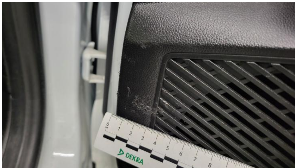
Fot. 69. Tapicerka drzwi tylnych P - Rysa/odprysk 1
