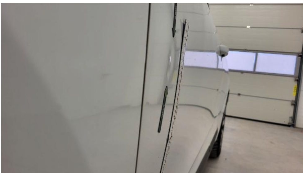
Fot. 61. Drzwi przed L - Wgniecenie/odkształcenie 1
