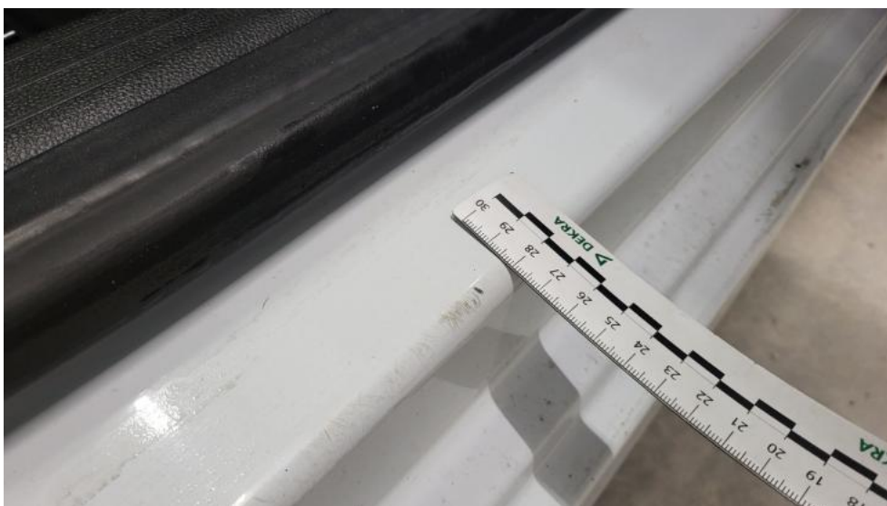
Fot. 52. Próg P - Rysa/odprysk 1
