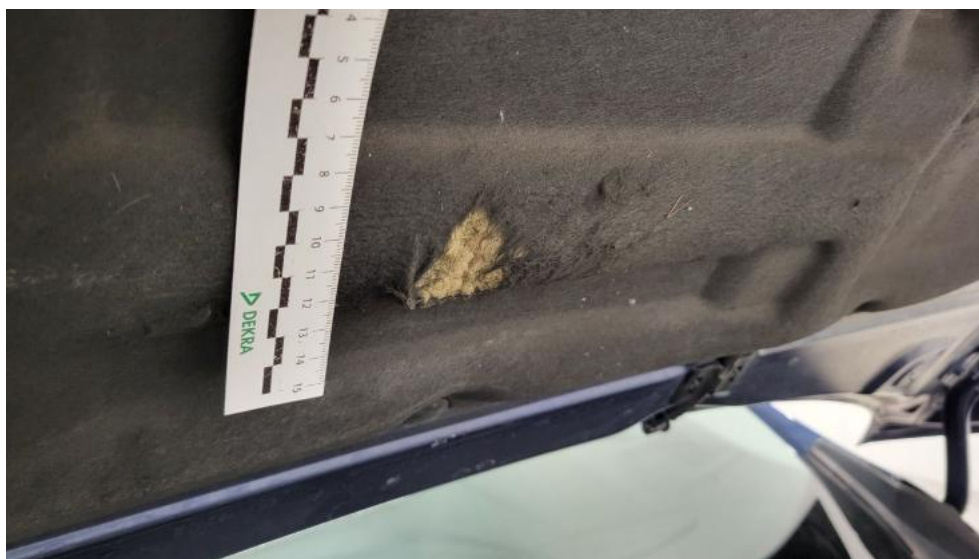
Fot. 49. Wykładzina pokrywy komory silnika - Pęknięcie/rozerwanie 1
