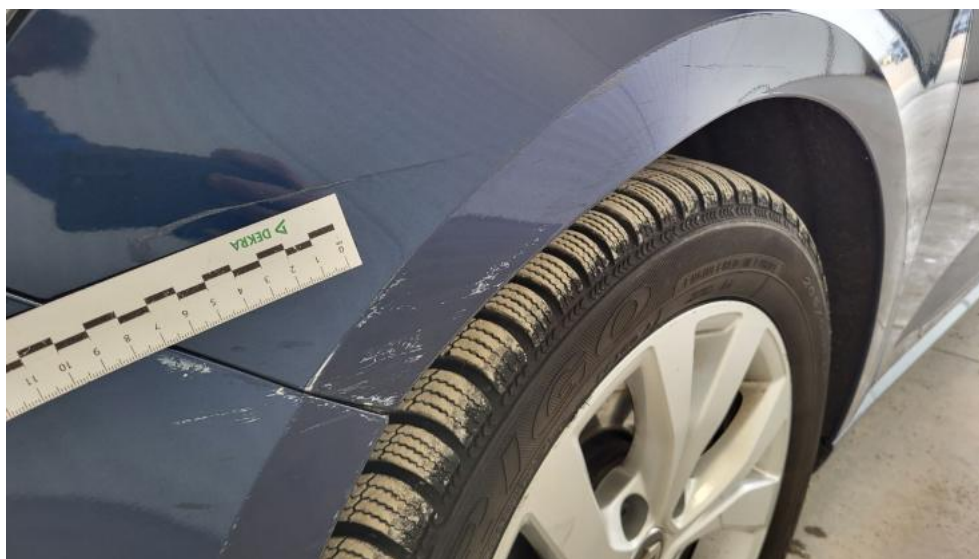
Fot. 85. Błotnik przedni L - Rysa/odprysk 1
