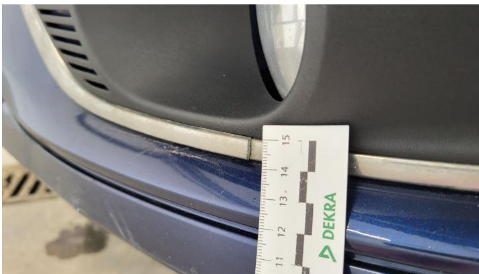
Fot. 42. Kratka/zaślepka halogenu L - Pęknięcie/rozerwanie 1
