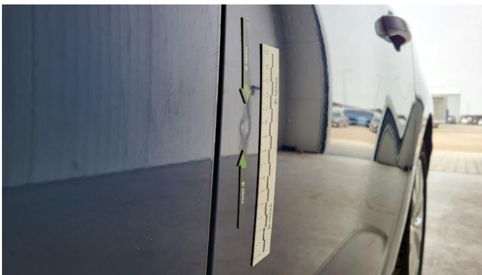
Fot. 82. Drzwi tylne L - Wgniecenie/odkształcenie 1
