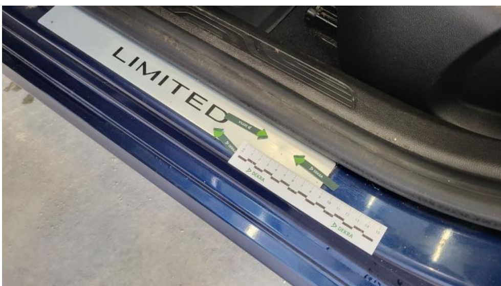
Fot. 84. Próg L - Wgniecenie/odkształcenie 1
