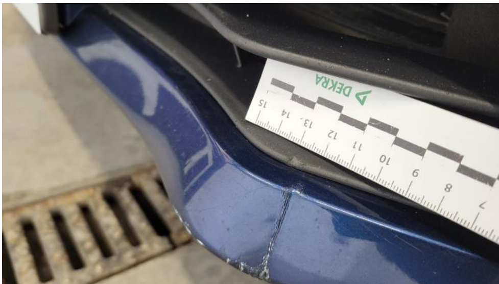
Fot. 41. Kratka zderzaka prz. - Rysa/odprysk 1
