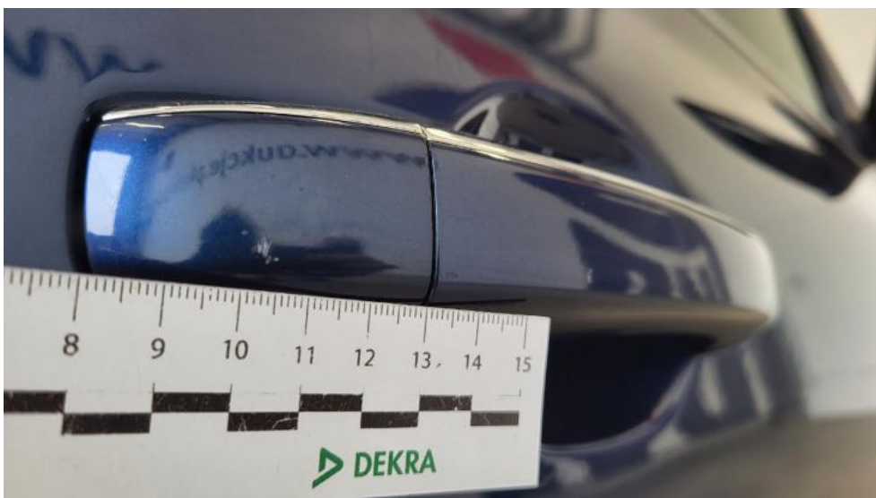
Fot. 62. Klamka drzwi prz P - Rysa/odprysk 1
