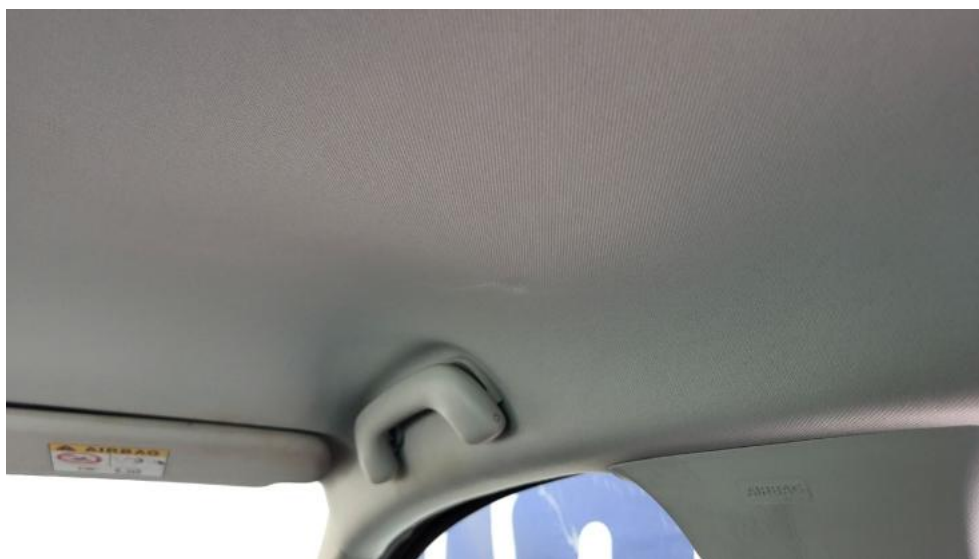
Fot. 99. Podsufitka - Wgniecenie/odkształcenie 1
