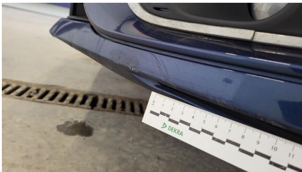
Fot. 51. Zderzak - Rysa/odprysk 2
