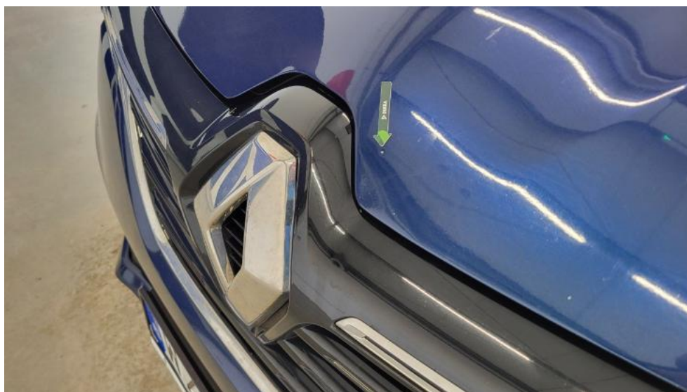
Fot. 45. Pokrywa komory silnika - Wgniecenie/odkształcenie 1
