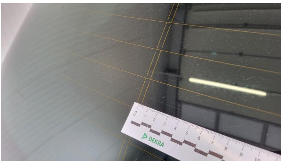
Fot. 72. Szyba tylna - Rysa/odprysk 1
