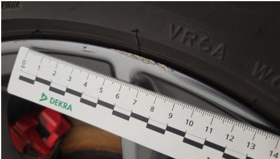
Fot. 51. Felga aluminiowa tylna P - Rysa/odprysk 1
