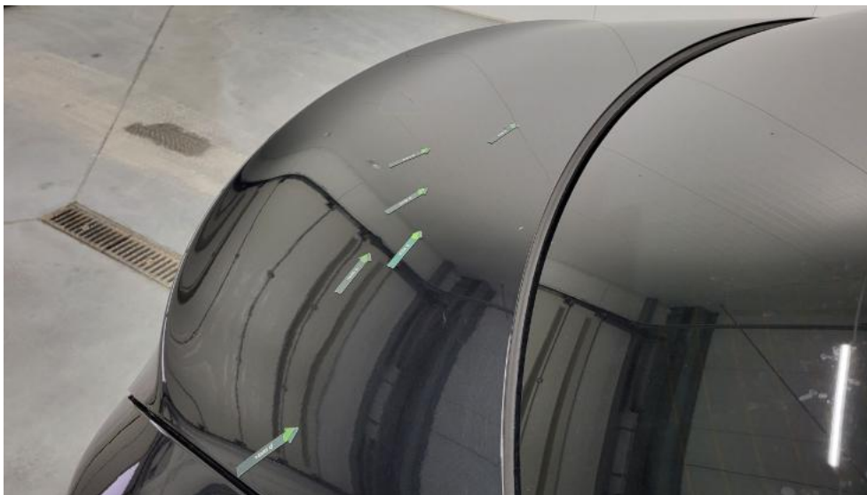
Photo 55. Pokrywy bagażnika - Wgniecenie/odkształcenie 1
