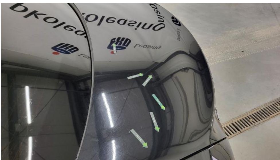
Photo 56. Pokrywy bagażnika - Wgniecenie/odkształcenie 2
