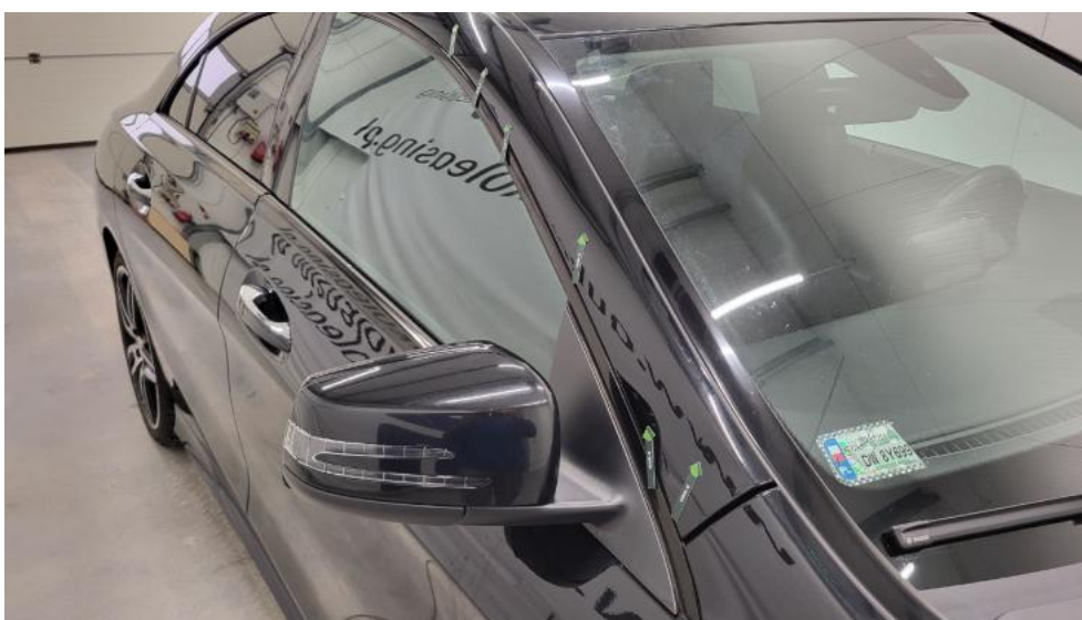
Photo 50. Słupek przedni P - Wgniecenie/odkształcenie 1
