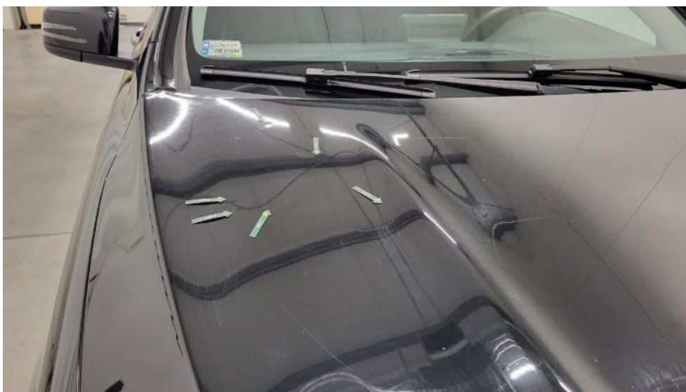
Photo 40. Pokrywa komory silnika - Wgniecenie/odkształcenie 1
