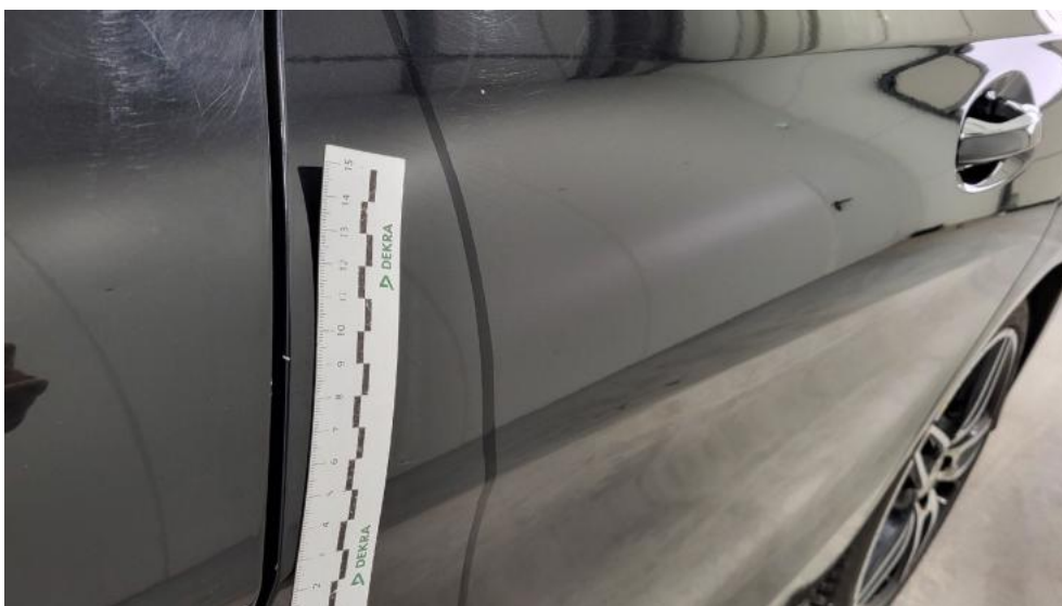
Photo 71. Drzwi tylne L - Rysa/odprysk 1
