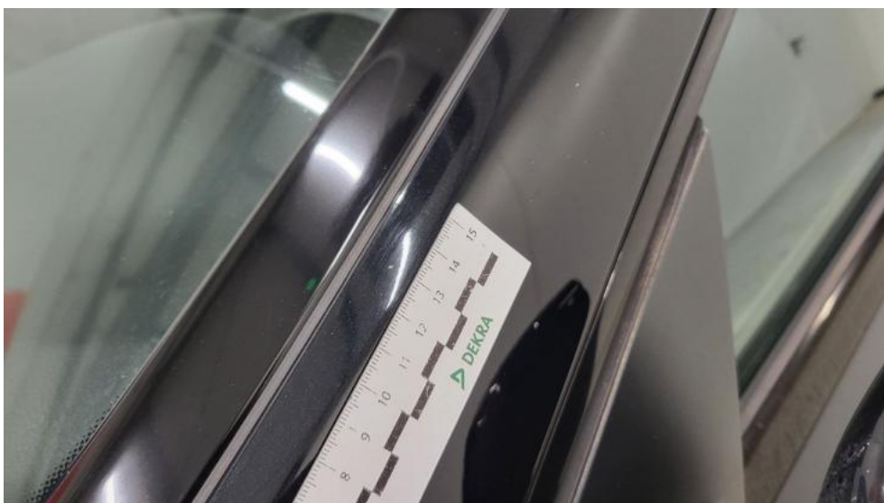
Photo 72. Słupek przedni L - Rysa/odprysk 1
