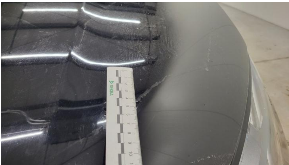
Photo 41. Pokrywa komory silnika - Rysa/odprysk 1
