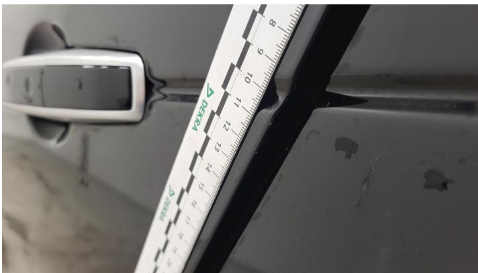
Photo 65. Drzwi tylne L - Rysa/odprysk 1
