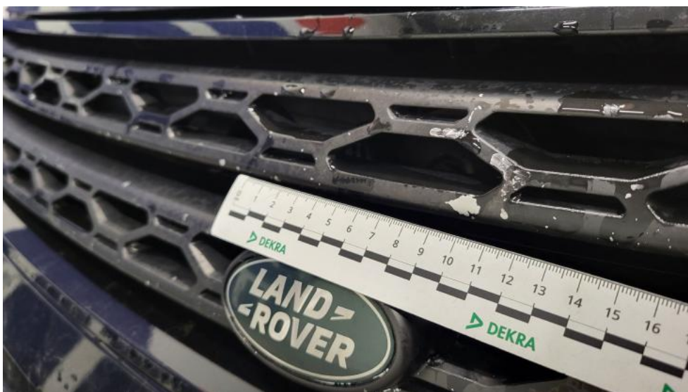
Photo 40. Atrapa przednia - Rysa/odprysk 1
