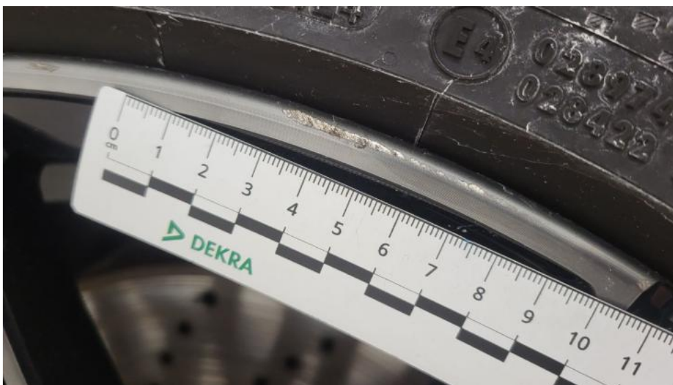
Photo 53. Felga Aluminiowa przednia L - Rysa/odprysk 1
