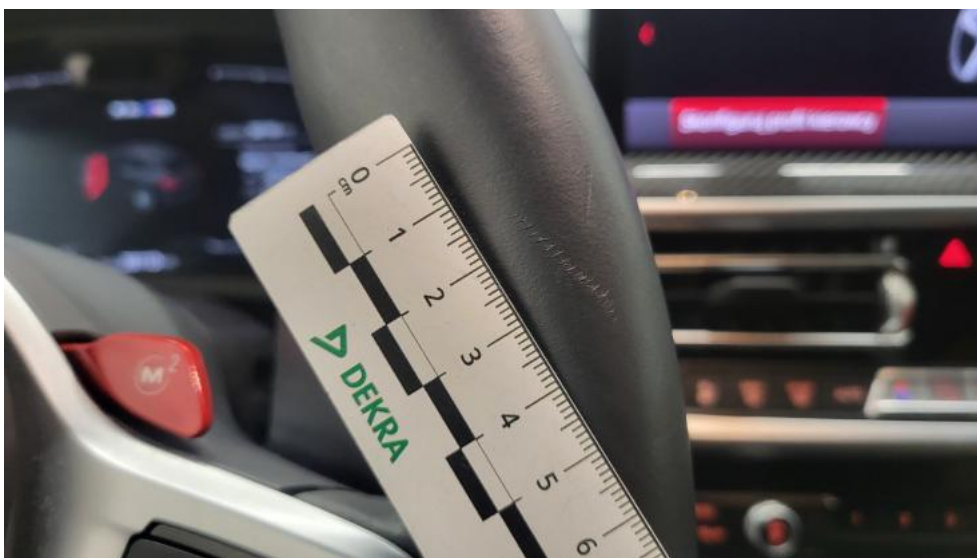
Photo 54. Koło kierownicy - Rysa/odprysk 1
