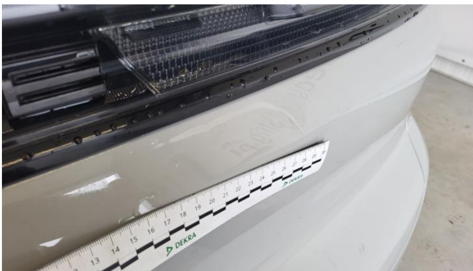
Photo 65. Pokrywy bagażnika - Rysa/odprysk 2
