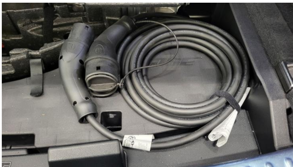
Photo 36. Przewód ładowania baterii trakcyjnej
