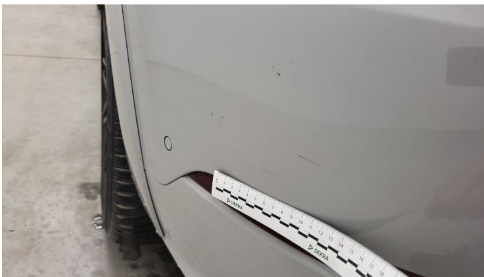
Photo 68. Zderzak tylny cz L - Rysa/odprysk 2
