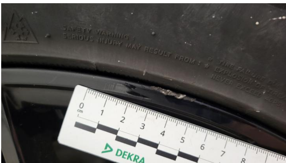
Photo 56. Felga aluminiowa przednia P - Rysa/odprysk 1
