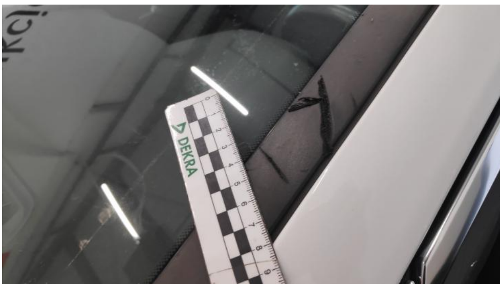
Photo 42. Uszczelka/listwa szyby czołowej - Rysa/odprysk 1
