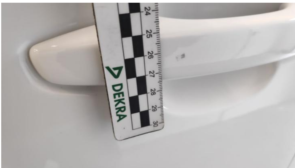
Photo 54. Klamka drzwi prz L - Rysa/odprysk 1
