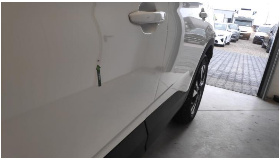
Photo 53. Drzwi przed L - Wgniecenie/odkształcenie 2
