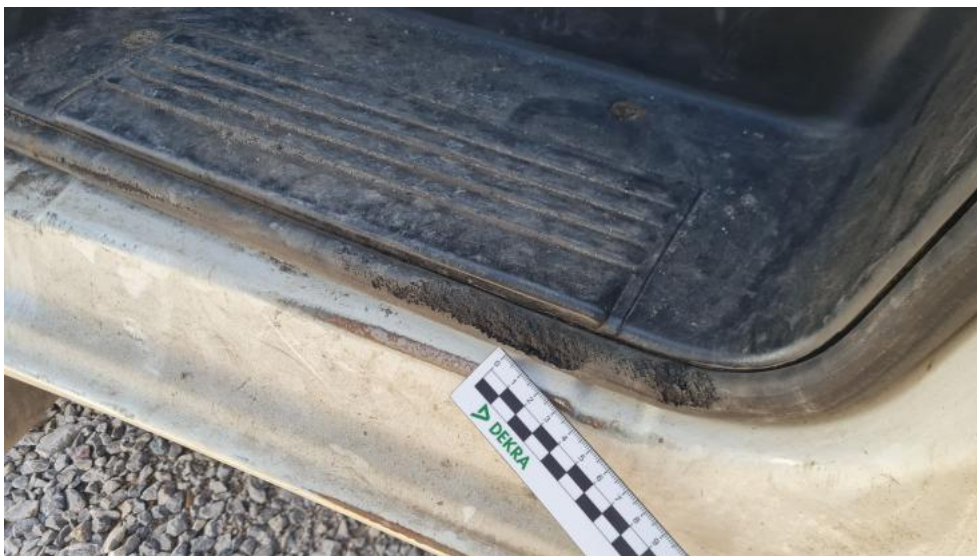
Photo 63. Uszczelka drzwi przednich L - Pęknięcie/rozerwanie 1
