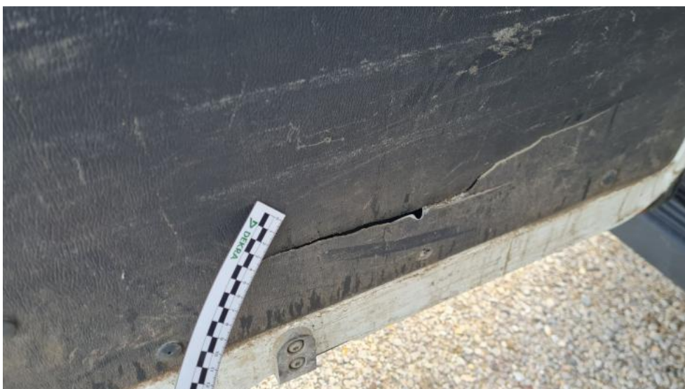
Photo 68. Drzwi tyłu lewe - Pęknięcie/rozerwanie 1
