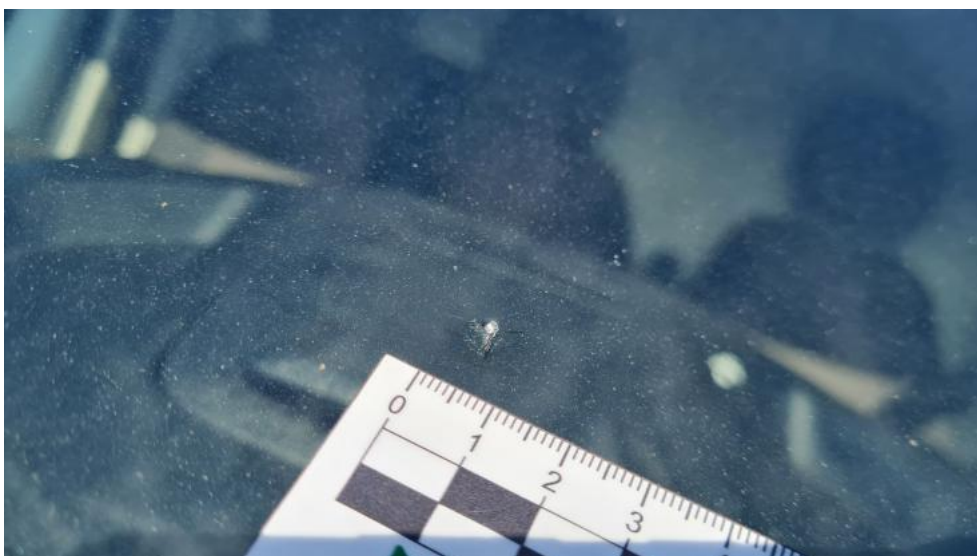
Photo 32. Szyba czołowa - Pęknięcie/rozerwanie 1
