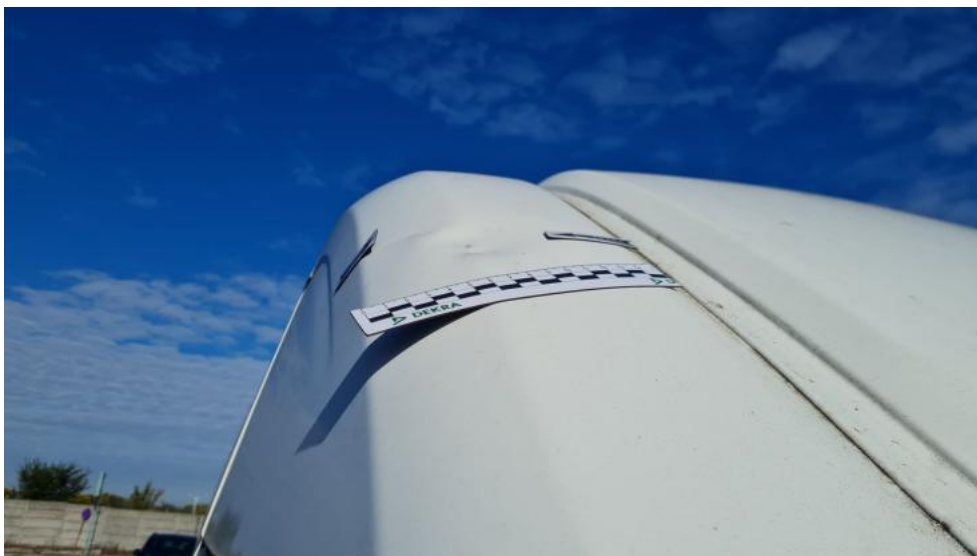
Photo 47. Stupek przedni P - Wgniecenie/odkształcenie 1
