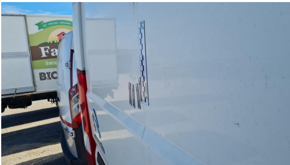
Photo 67. Drzwi tyłu lewe - Wgniecenie/odkształcenie 1
