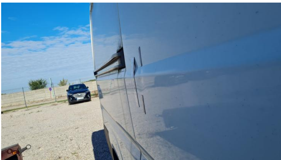
Photo 42. Drzwi tylne P - Wgniecenie/odkształcenie 2
