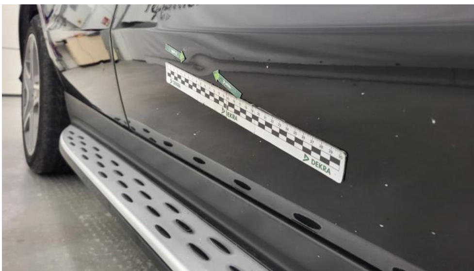
Photo 61. Drzwi przednie P - Wgniecenie/odkształcenie 1
