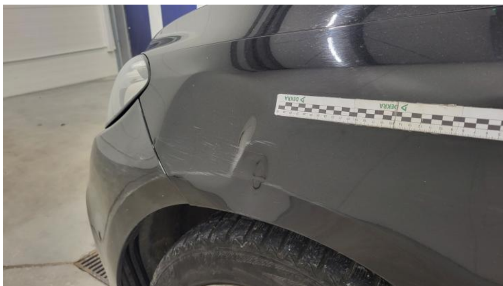
Photo 84. Błotnik przedni L - Rysa/odprysk 1
