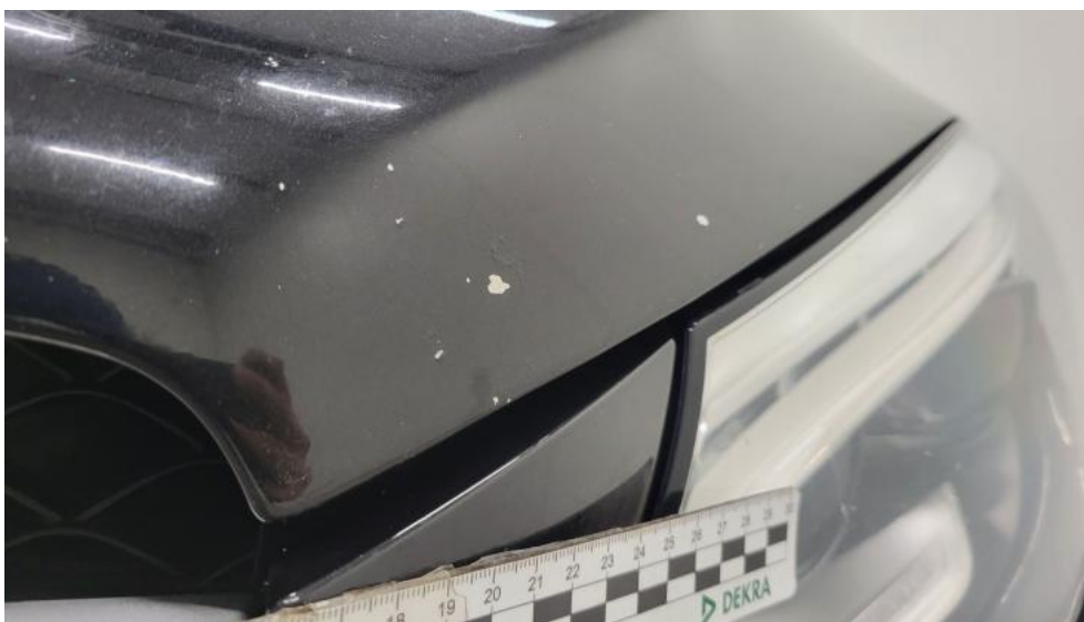
Photo 43. Pokrywa komory silnika() - Rysa/odprysk 3
